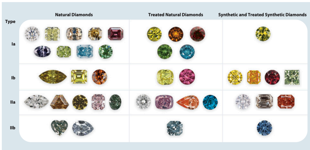
Figura 2.12 El color fuertemente influido por las impurezas/defectos en la red cristalina del diamante. Foto GIA( 2009).
