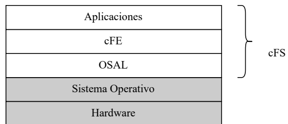
Figura 8.1: Capas de cFS (adaptado de [7]).
