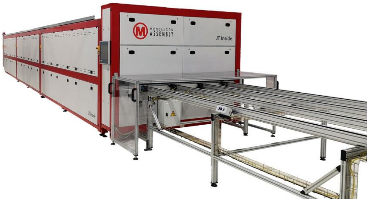
Figura 7. Laminadora de paneles fotovoltaicos. Imagen ilustrativa. Tomado de (Mondragon Assembly, 2022).
