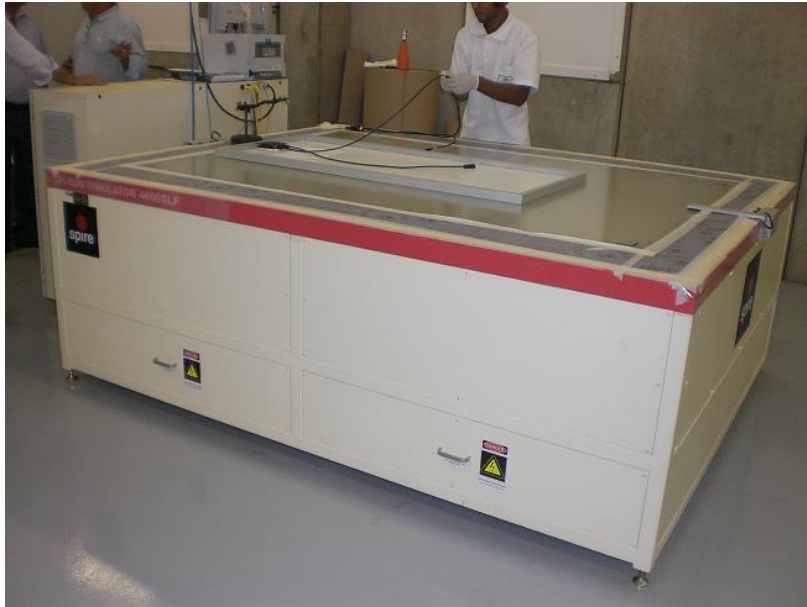
Figura 8. Prueba de simulación solar con un equipo SPI-SUN.SIMULATOR 4600 SLP SPIRE SOLAR. Imagen ilustrativa. Tomado de (Herrero, 2016)
