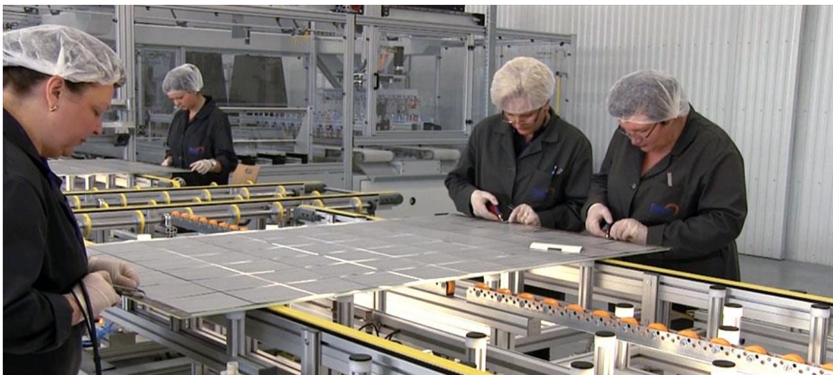
Figura 6. Operación manual de soldadura de celdas fotovoltaicas. Imagen ilustrativa. Tomado de (Solarview, 2021)
