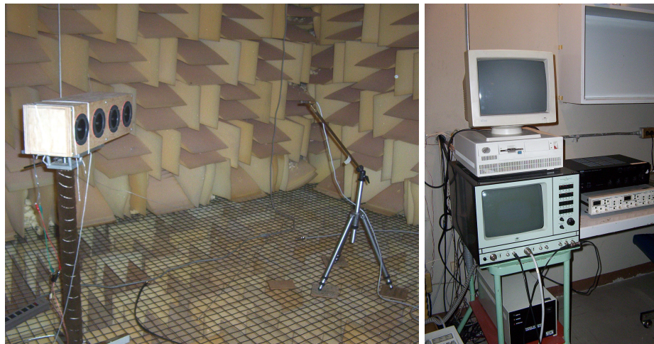
Fig. 4.11. Arreglo de medición de direccionalidad de los altavoces. En la cámara anecoica (izquierda) y el cuarto de control (derecha).
