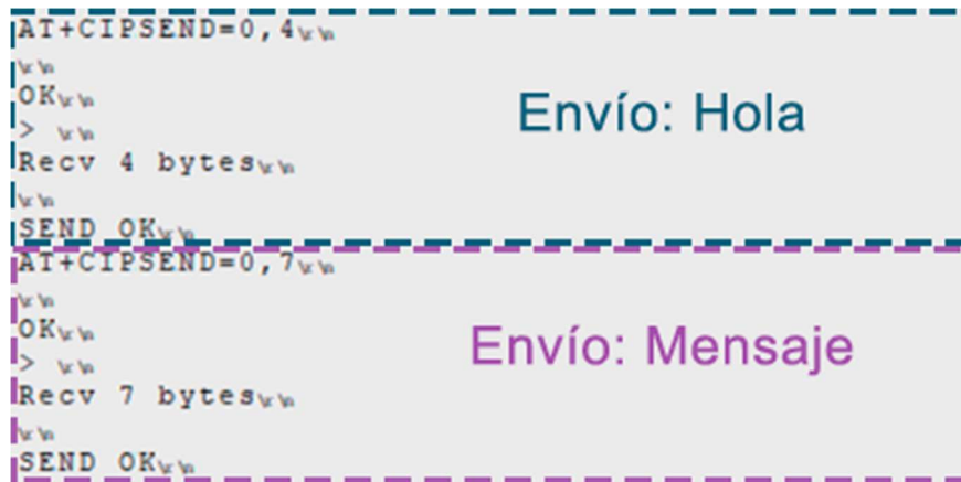
Figura 3.9 Ejemplo de una ejecución de comandos AT en funciones de envío de mensaje.
