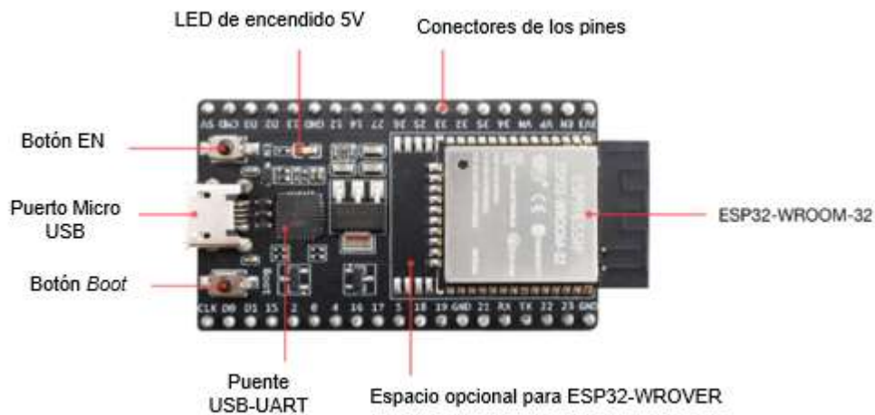
Figura 4.3 ESP32_DevKitC V4. Modificado de [57].
