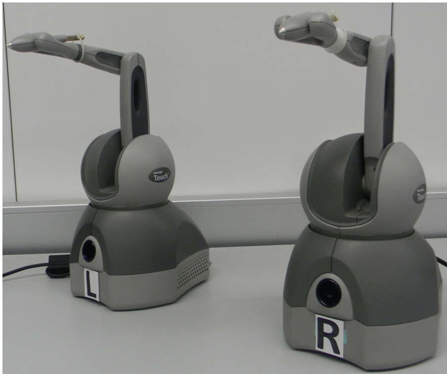
Figura 4.1: Sistema teleoperado de dos robots Geomagic Touch
