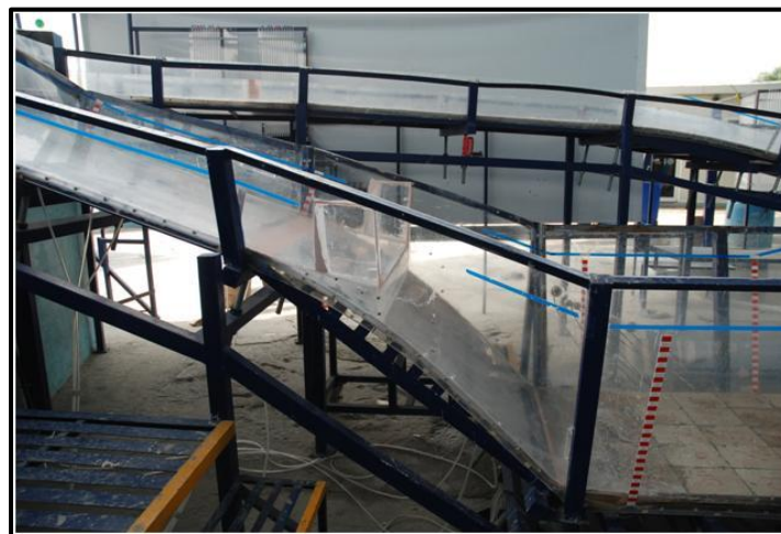
Figura 3.33 Salto de esquí corto con deflectores laterales (CFE, 2014)
