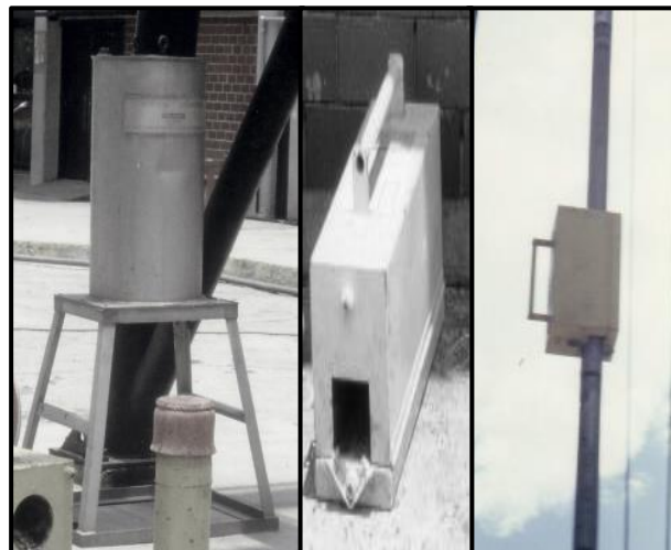
Figura 9.22. Tanque de agua (izquierda), contenedor de ^{60}\text{Co} y calibración de sonda de neutrones (derecha) (Castrejón et al., 2024).
