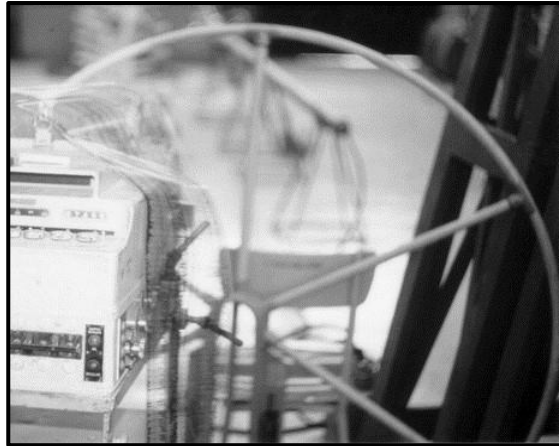
Figura 9.20. Aro de resistencias para calibrar las sondas de inducción (Castrejón et al., 2024).
