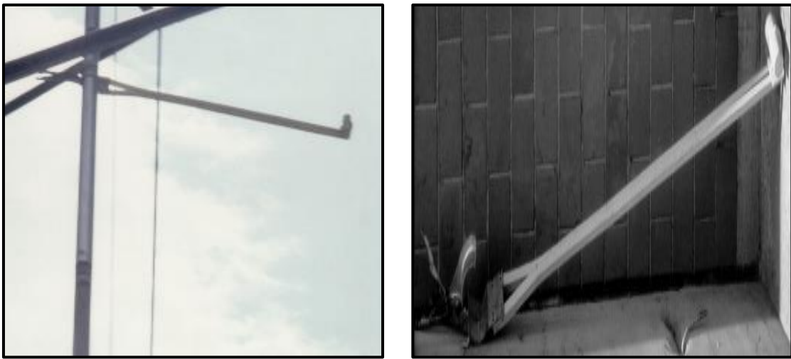
Figura 9.19. Regla de calibración de sonda de GR (Castrejón et al., 2024).
