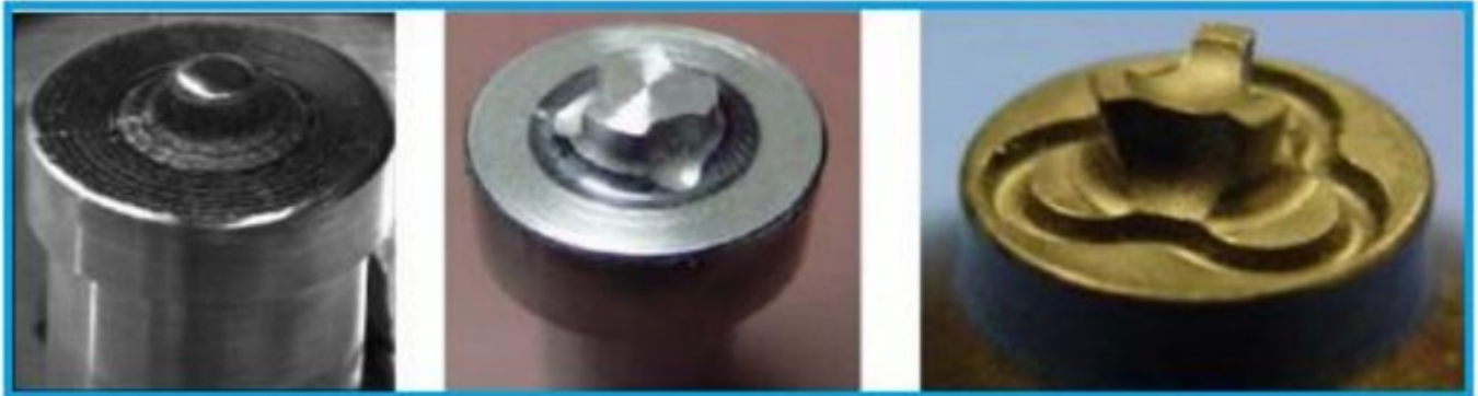
FIGURA 5.3 Diseño de hombros para soldadura por fricción - agitación.
