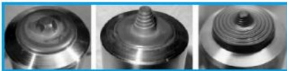
FIGURA 5.4 Diseño de pin para soldadura por fricción - agitación.
