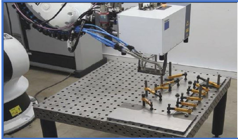
Figura 8.5 Esta fijación de soldadura a solape usa varias abrazaderas para asegurar el contacto apropiado entre dos chapas. Fuente.
