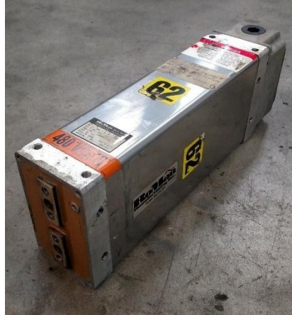
FIGURA 3.12 Transformador ROMAN utilizado en la soldadura por resistencia.
