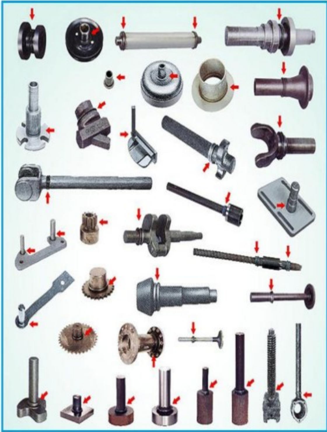
FIGURA 5.27 Diversos componentes fabricados por soldadura por fricción.
