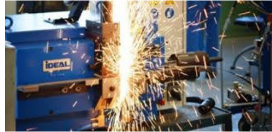
FIGURA 3.8 Soldadura instantánea (FW); (1) calentamiento mediante resistencia eléctrica y (2) recalado (las piezas se presionan una contra la otra).
