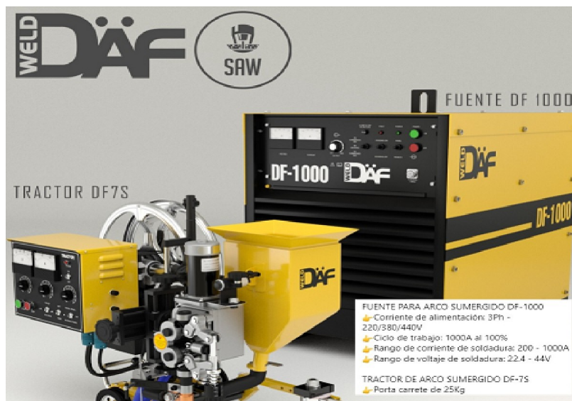
Figura 2.5.3 Utiliza un equipamiento que realiza la soldadura sin requerir un operario que ajuste los controles.
