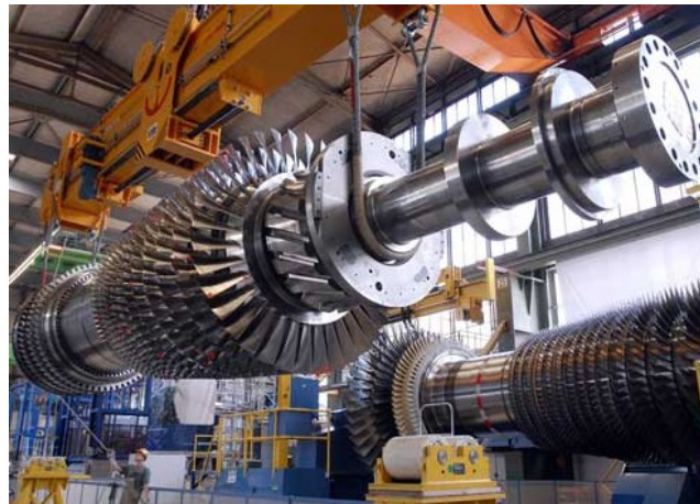
FIGURA 5.22 La industria de las turbinas de gas está volcada en una mejora para mayor eficiencia y seguridad, empleado soldadura por fricción.
