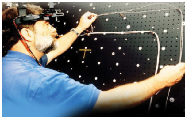
Figura 43: En esta imagen se puede observar a una persona utilizando la HMD creada en 1992 por los ingenieros de Boeing David Mizell y Thomas Caudell para facilitar la colocación del cableado en las aeronaves.[60]
