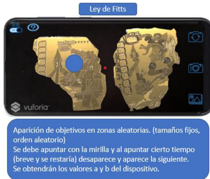
Figura 129: Prototipo para el experimento de Fitts.
