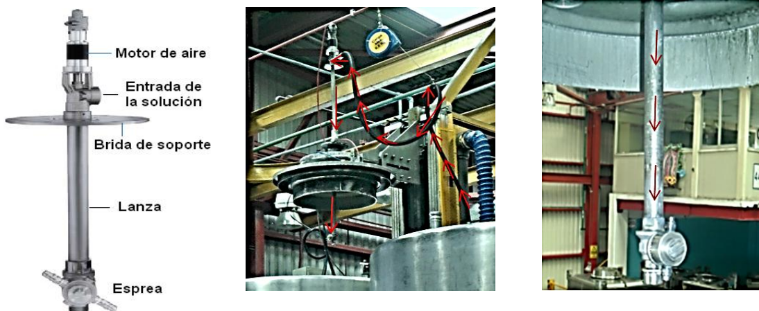
Figura 3.14 Flujo de la solución alcalina a través de la tapa
