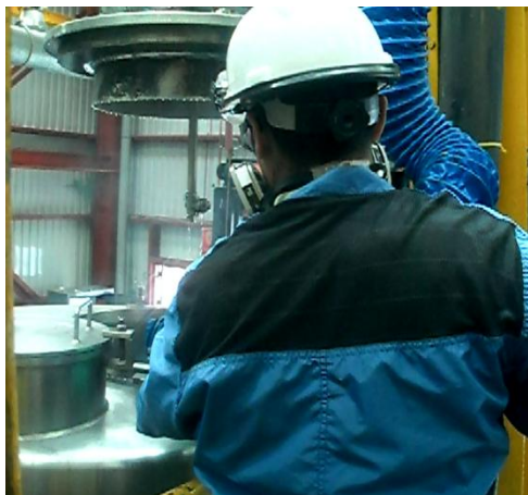
Figura 3.36 Exposición a vapores de NaOH al abrir la tapa e introducir la manguera de extracción
