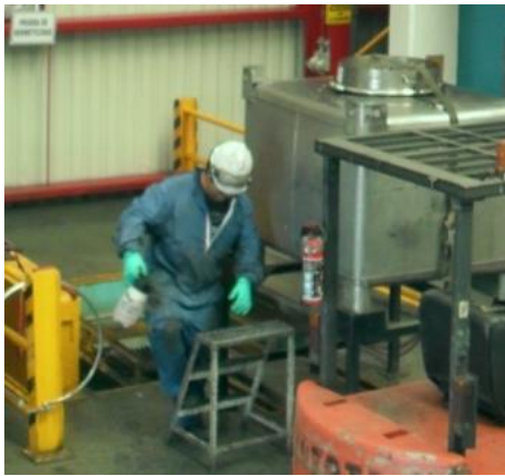
Figura 3.33 Preparación del recipiente para realizar la prueba de hermeticidad
