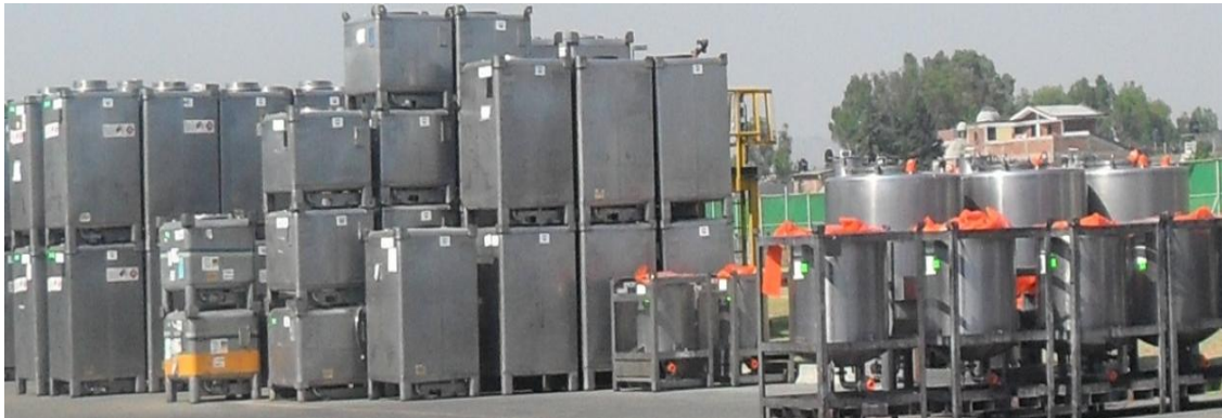
Figura 3.3 Totes y tinas de diferentes capacidades (2000, 8000 y 10000 litros aprox.)
