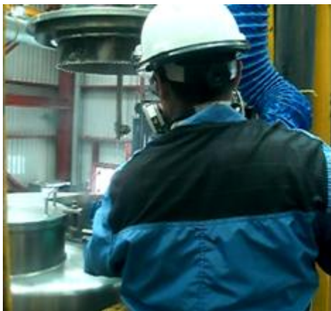
Figura 3.45 Operación manual, introducir manguera de extracción al terminar el ciclo de lavado a base de sosa
