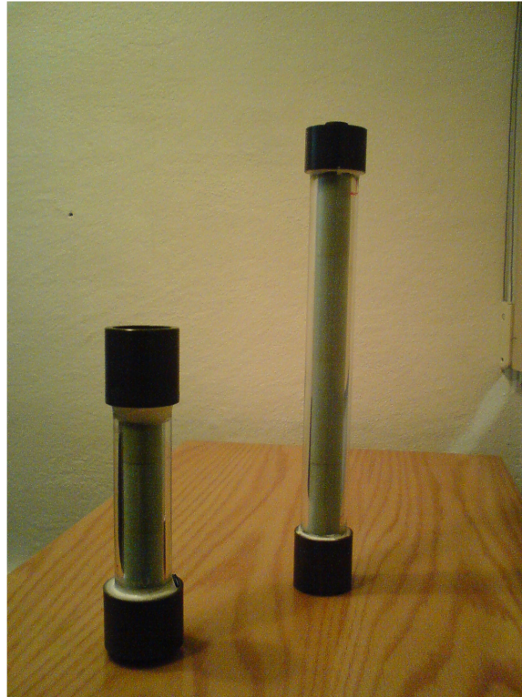
Figura 4. 7. Las dos terminaciones utilizadas con el tubo, rellenas con espuma de poliuretano para darles diferente absorción.
