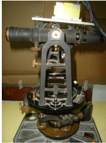
Fig. 2.14 Acelerómetro fijado al teodolito
