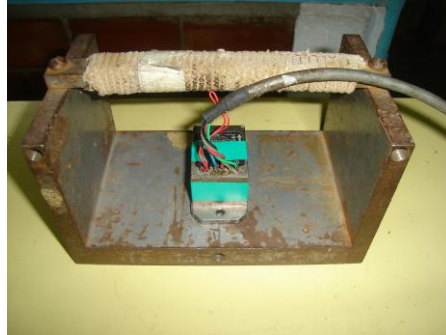
Fig. 2.20 Acelerómetro montado sobre base metálica
