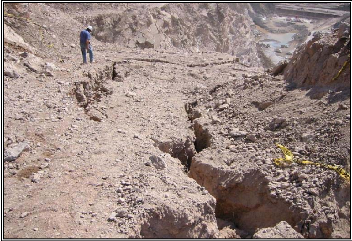
Fotografía 26.- Grietas de tensión generadas por el derrumbe en la zona de la subestación provocadas por la Falla Lagartija SE.
