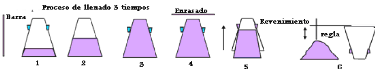
Fig. I.5 Obtención del revenimiento según la norma ASTM-C-143
