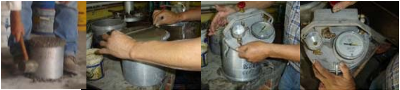
Fig. III.6 Obtención del contenido de aire en el laboratorio, según la norma ASTM-C-231
