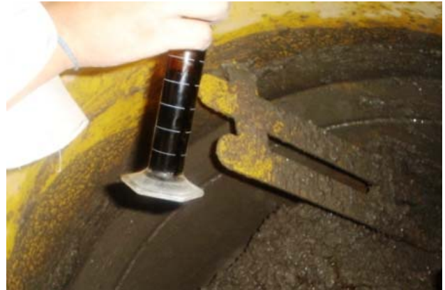
Fig. III.3 Colocación del aditivo a la mezcla
