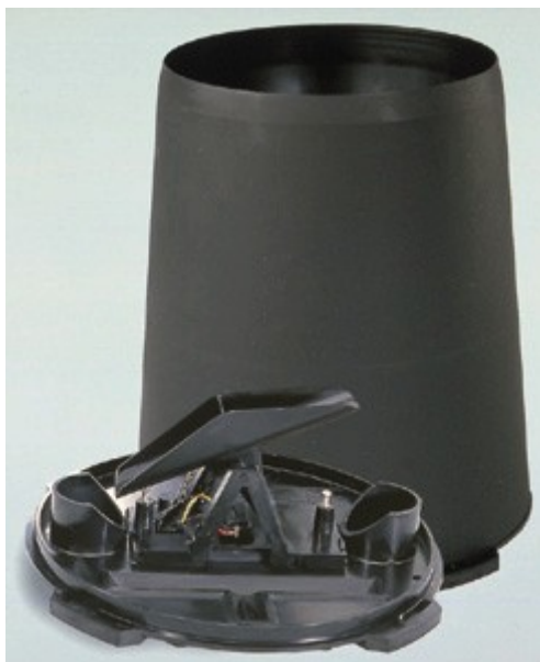
Fig. 3.4 Pluviógrafo de balancín. (Atmósfera, 2006)
