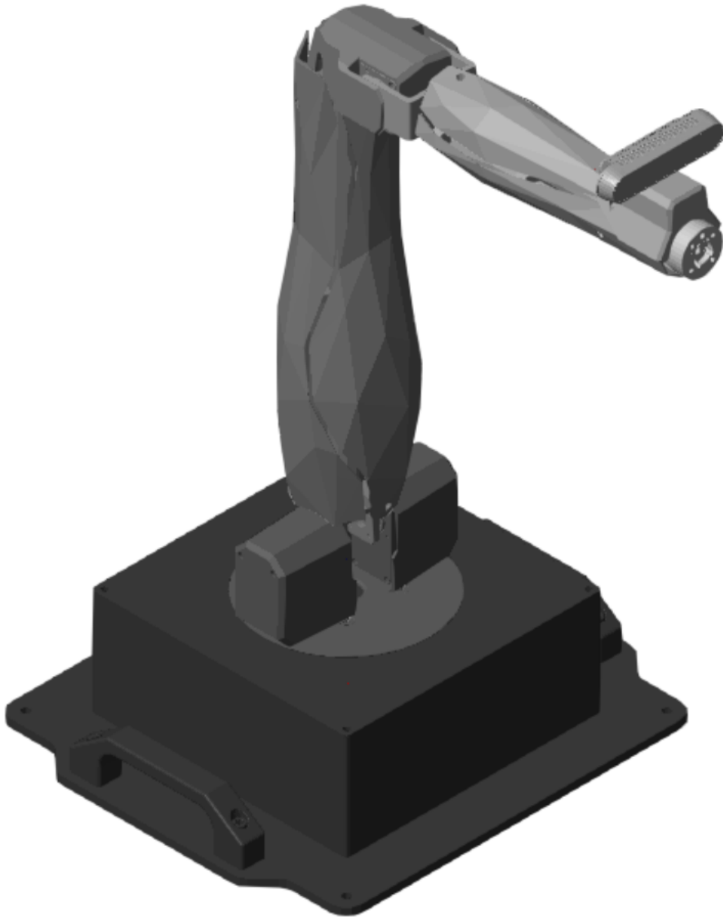
Figura 3.2: Modelo del QArm en Simscape-Simulink utilizado para la evaluación de los controladores.
