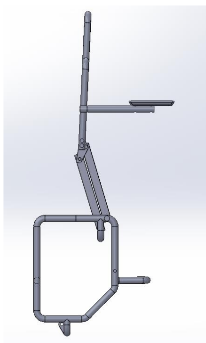
Figura 22. Vista lateral de la silla bipedestadora en posición bípeda
