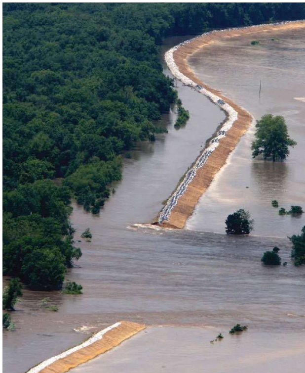
Figura 4. La ruptura de este dique en Illinois durante la inundación del río Misisipi en 1993 provocó el anegamiento del pueblo de Valmeyer. Tomada de Keller y DeVecchio (2019).
