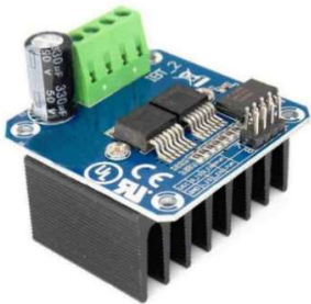
Figura 24. Puente H BTS7960 [22].
