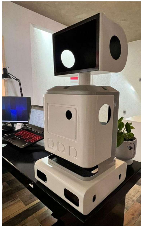
Figura 22. Carcasa en fibra de vidrio mandada a hacer.
