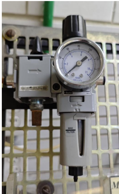
Ilustración 17: Unidad de mantenimiento
