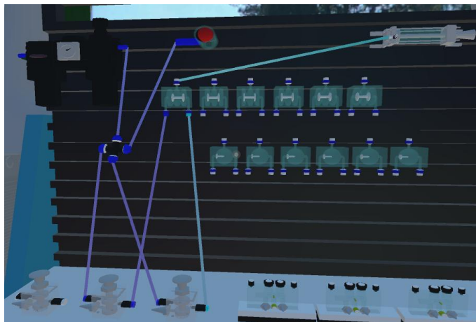
Ilustración 87: Accionamiento del botón izquierdo en la primera prueba de integración de la válvula And
