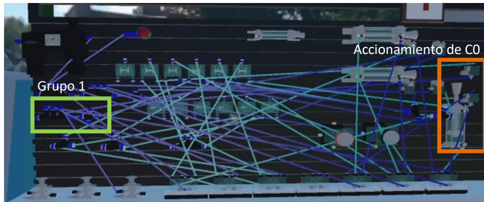
Ilustración 120: movimiento C- y accionamiento del grupo 1 en la prueba funcional
