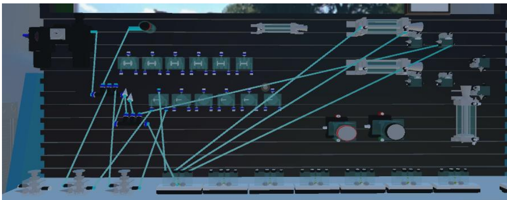
Ilustración 103: circuito de la segunda prueba de integración de la válvula Or
