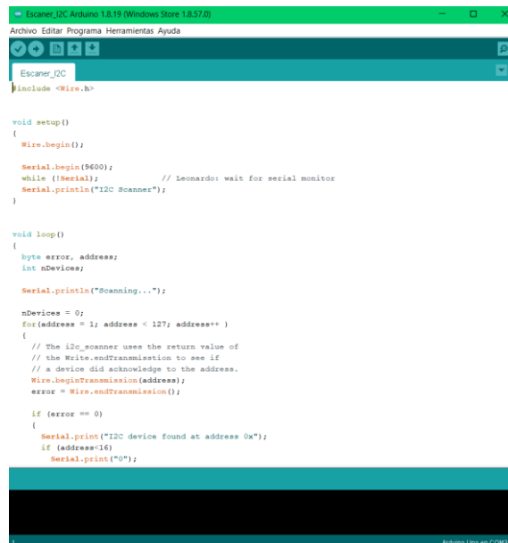
Figura 2.53 Prueba de escáner I2C para comprobar las direcciones de los sensores de temperatura (Arduino S.R.L, s.f.).
