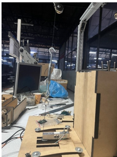
Figura 2.75 Vista del sistema de sensor de fuerza y cables de dirección de fuerza.
