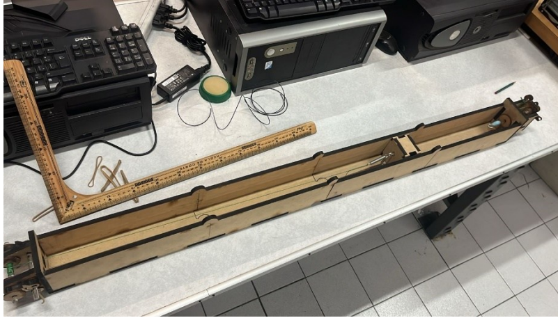
Figura 2.77 Aparato para torsionar y entrenar fibras musculares artificiales de nylon.
