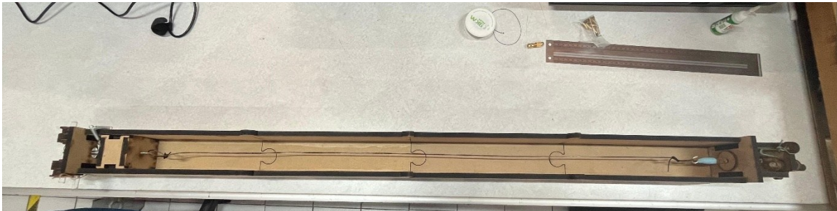
Figura 3.8 Aparato para torsionar con muestra antes de entrenar.
