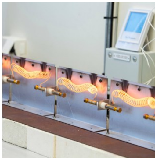
Figura 2.9 Transferencia de calor por conducción de resistencia (Kanthal, s.f.).
