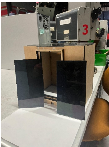
Figura 2.74 Vista de la carcasa de seguridad con sus paneles removibles.
