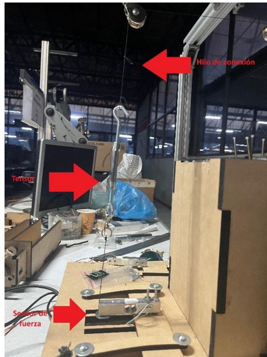
Figura 3.18 Diagrama de conexión de sensor de fuerza con el tensor y el hilo de conexión a la muestra.
