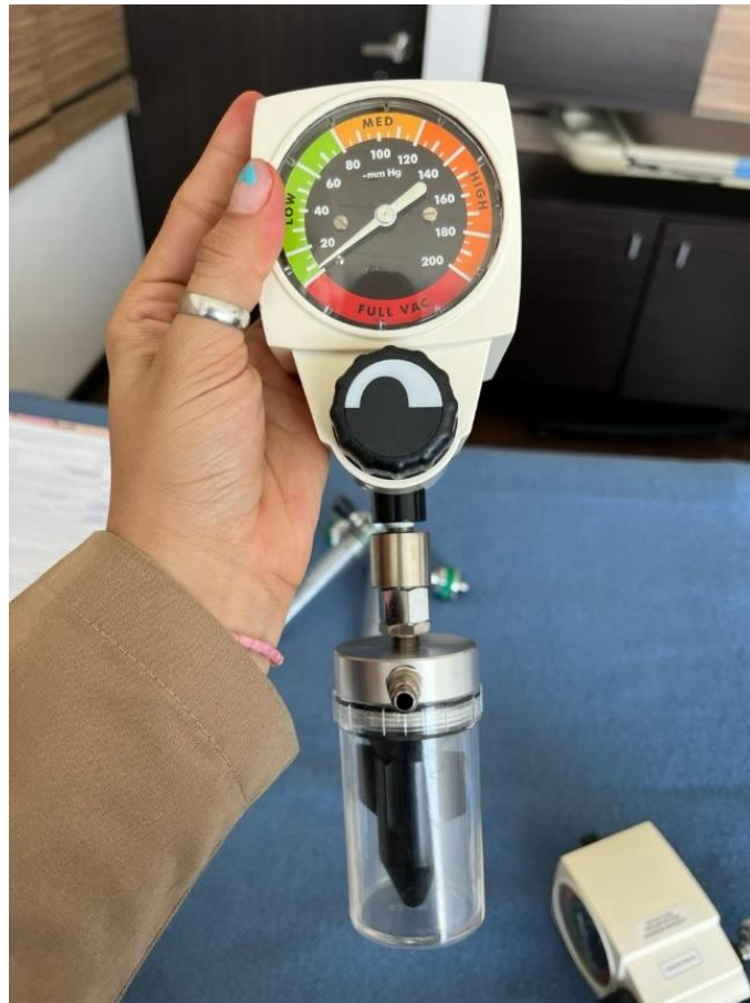
Figura A.2. Regulador de vacío; ejemplo de equipo médico del Qx al que los ingenieros del DIB realiza mantenimiento preventivo. Otros ejemplos son: lámparas quirúrgicas y flujómetros.
