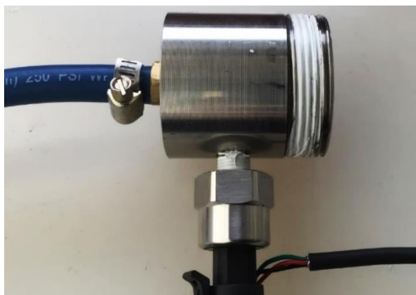
Figura 48. Conexión del porómetro con cada uno de sus componentes ejemplificados con la estructura de bloqueo.
