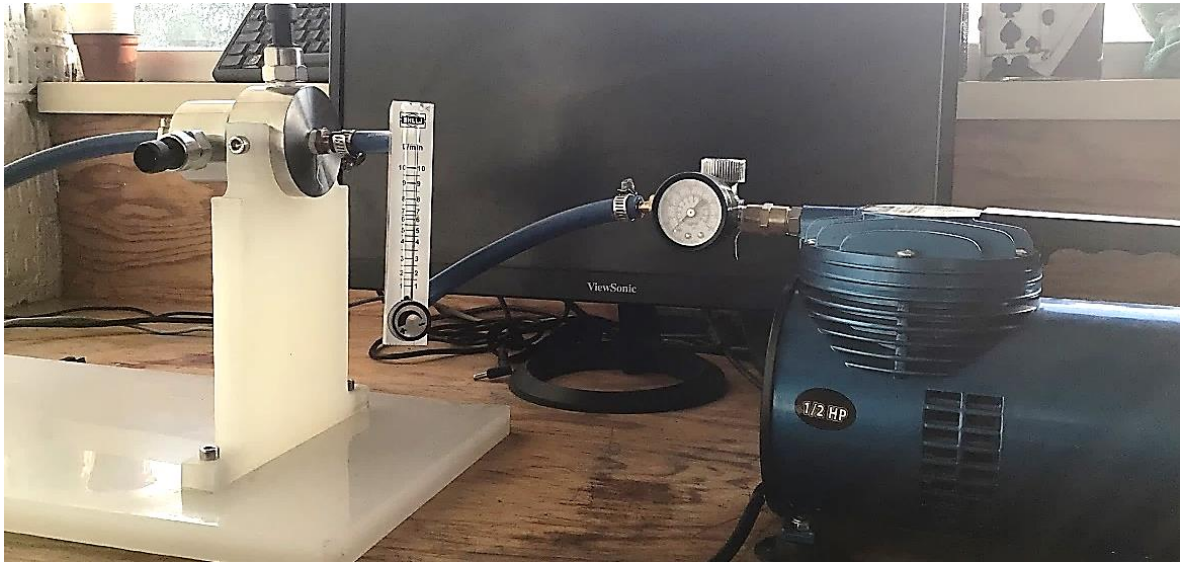
Figura 46. Sistema de porometría ensamblado antes de las pruebas.
