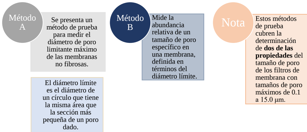
Figura 9. Tipo de métodos descritos en la norma ASTM-F316-03(2019).
