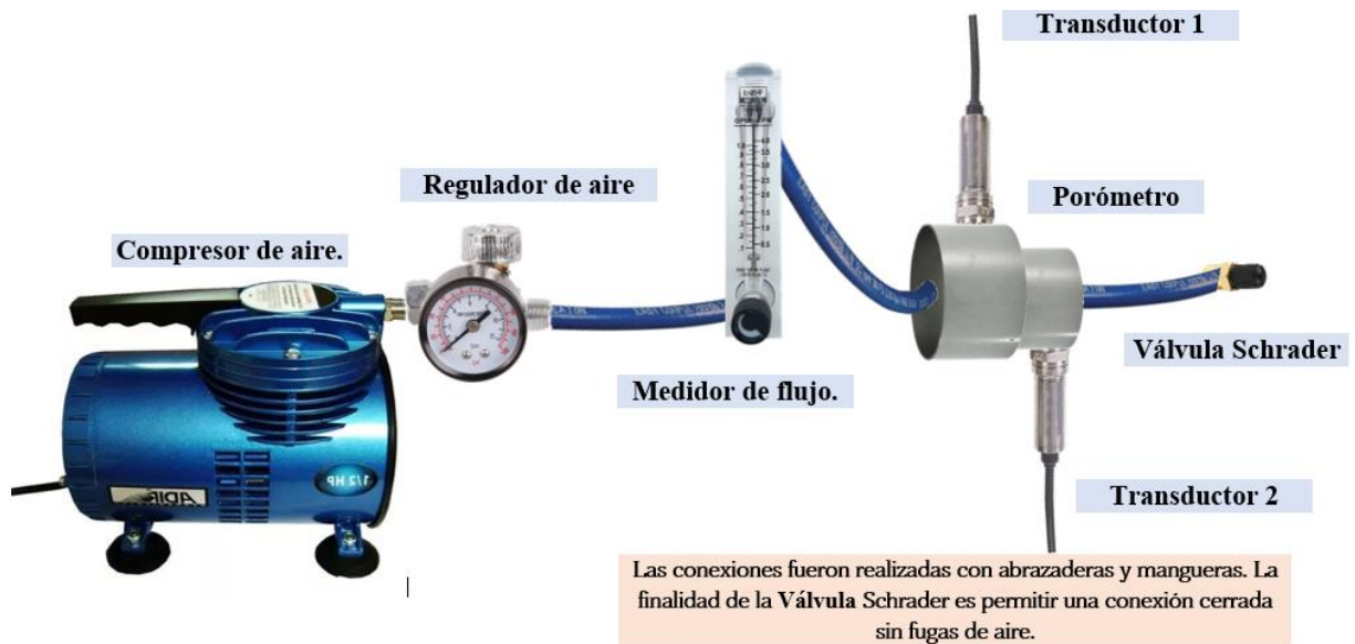
Figura 44. Diagrama de funcionamiento del porómetro por control de cantidad de flujo de aire.
