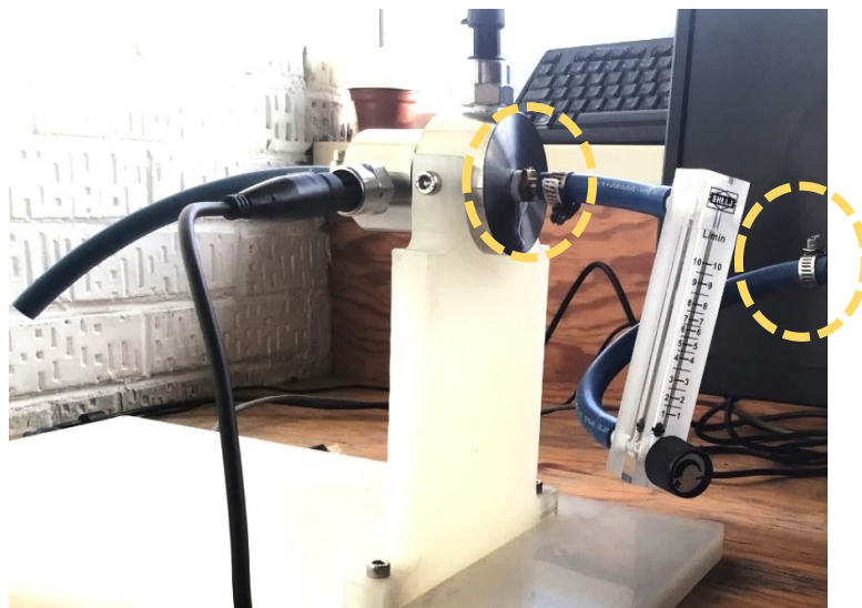
Figura 47. Sistema de porometría ensamblado antes de las pruebas.
