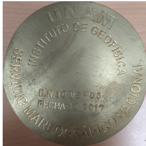
Figura 3.2: Placa de nivel grabada correspondiente a la estación de Veracruz, Veracruz.
