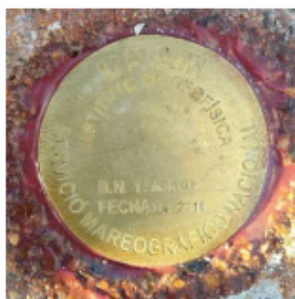
Imagen 1. Banco de nivel instalado.
