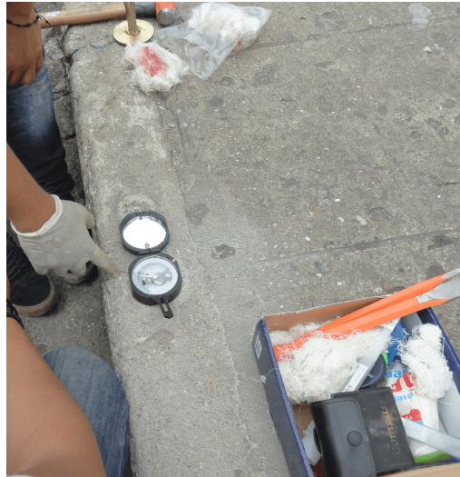
Figura 3.3: Orientación de la placa de nivel al Norte en Frontera, Tabasco.
