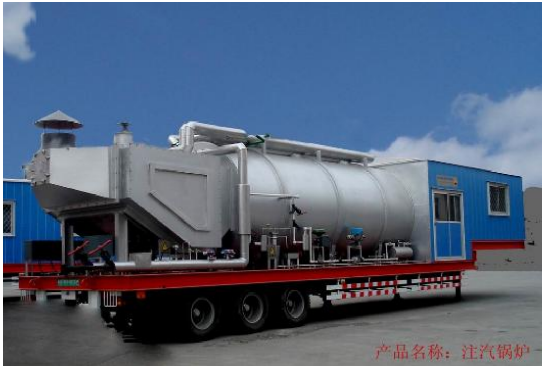
Figura 7.4 Generador de vapor
