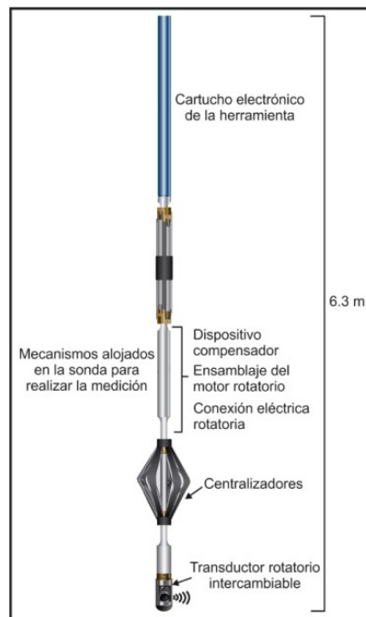
Fig. 170 – Diseño de la herramienta UBI propiedad de la compañía Schlumberger (Ricco, 2012).
