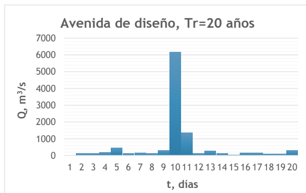
Figura 4.28. Avenida de diseño con el método de bloques alternos, Tr=20 años
