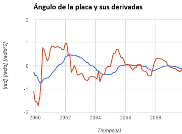
Figura 5.4 Roll de la placa, filtrado y su primer derivada, por 10 s.
