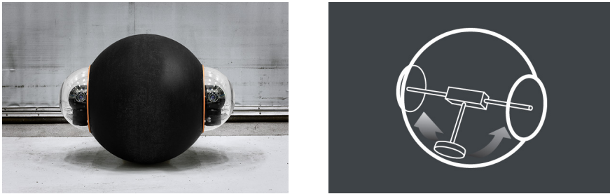
Figura 2.7 Robot GroundBot, desarrollado por Rotundus (izquierda) y su configuración interna (derecha) [17].
