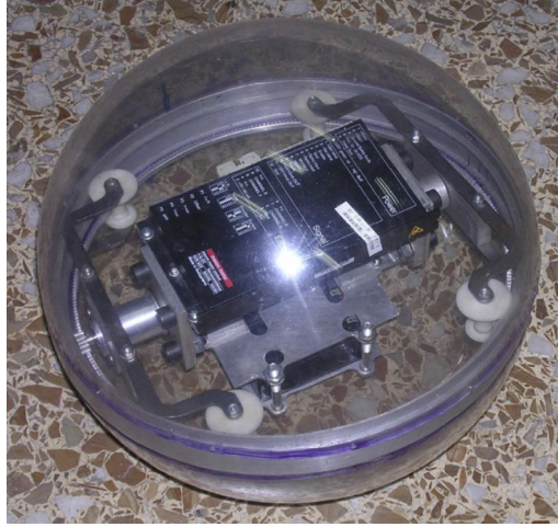
Figura 2.5 Sistema de orientación del robot HIT [22].
