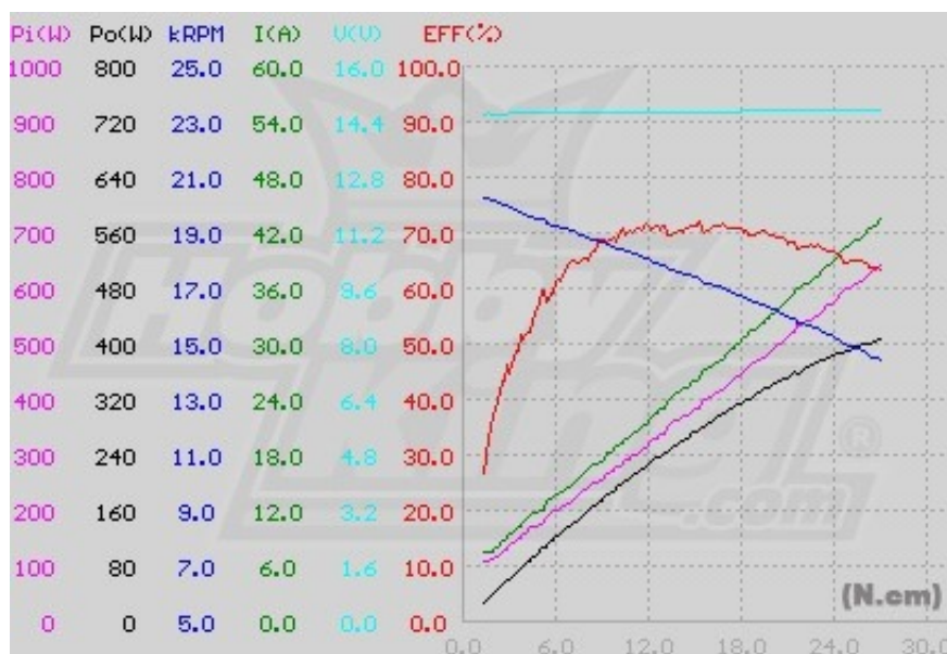
Figura A.9 Curvas características del motor NTM Prop Drive Series 35-30A 1400kv a 15 V.
