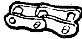
FIG. 2.4 CADENA DE ESLABONES SENCILLOS
