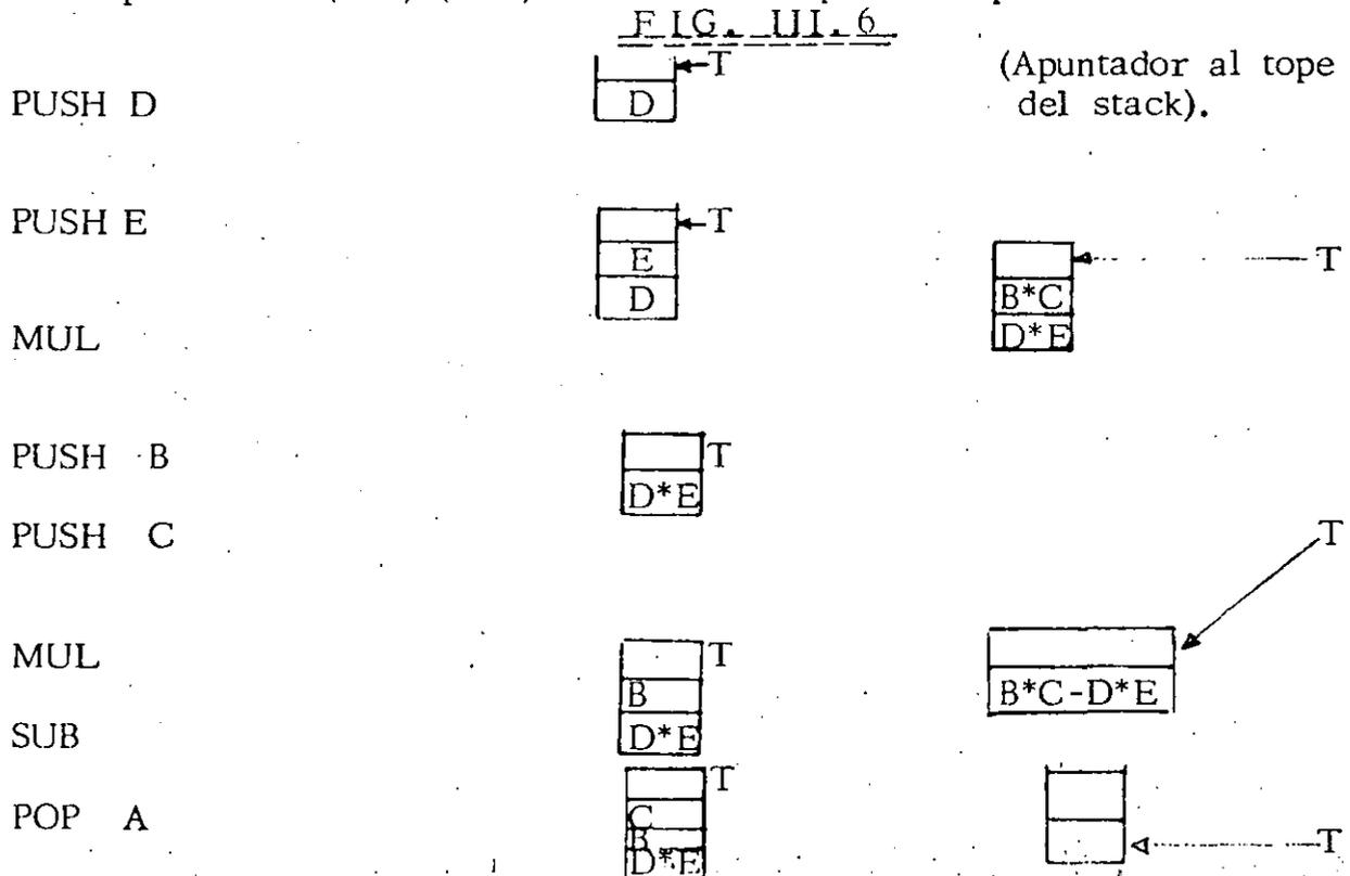
En la fig. III.6 se ilustra el estado del stack después de cada una de las inst. anteriores.
