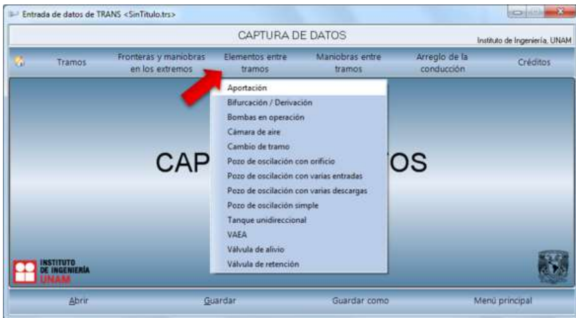
Fig. 6.15 Elementos entre tramos.
