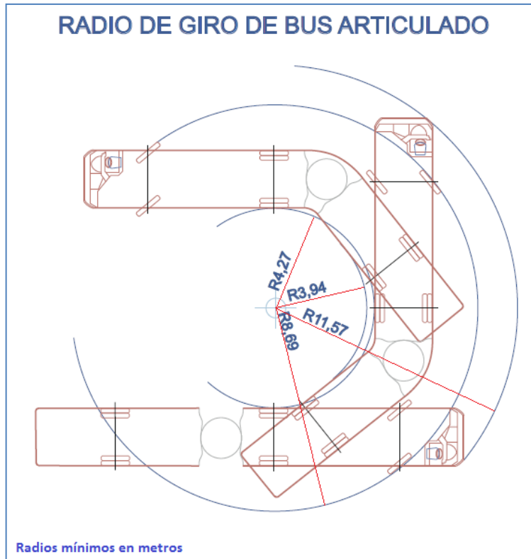
Figura 2.14. Radio mínimo de giro para permitir que un vehículo articulado cambie de de sentido con seguridad.
