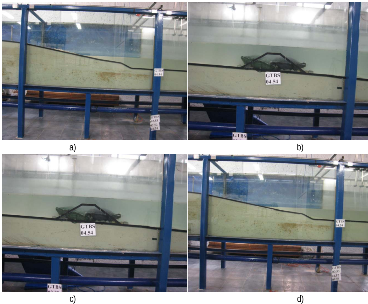
Figura C.76 Condiciones de la prueba GTBS0454. a) Perfil inicial de la playa, b) Perfil final de la playa, c) Condición inicial de la estructura, b) Condición final de la estructura
