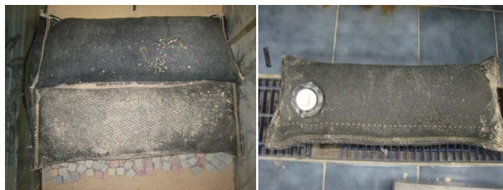
Figura 2.12 Modelo fabricado con geotubos®
