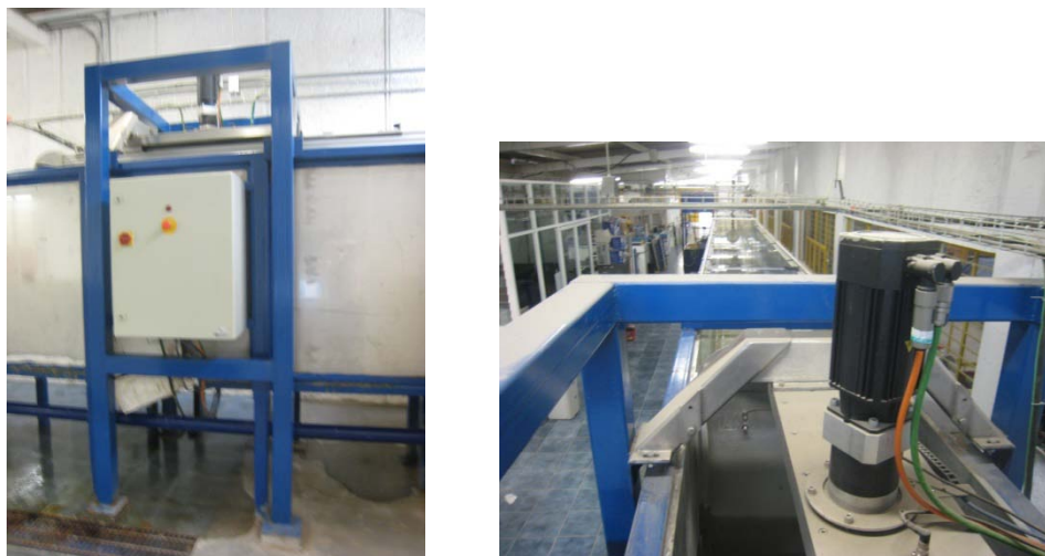
Figura 2.2 De izquierda a derecha; soporte del sistema de generación de oleaje y motor eléctrico
