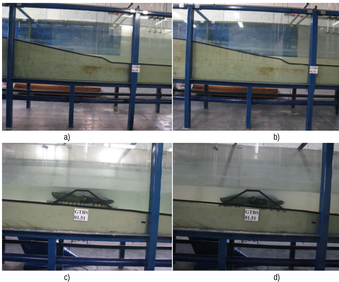
Figura C.70 Condiciones de la prueba GTBS0151. a) Perfil inicial de la playa, b) Perfil final de la playa, c) Condición inicial de la estructura, b) Condición final de la estructura
