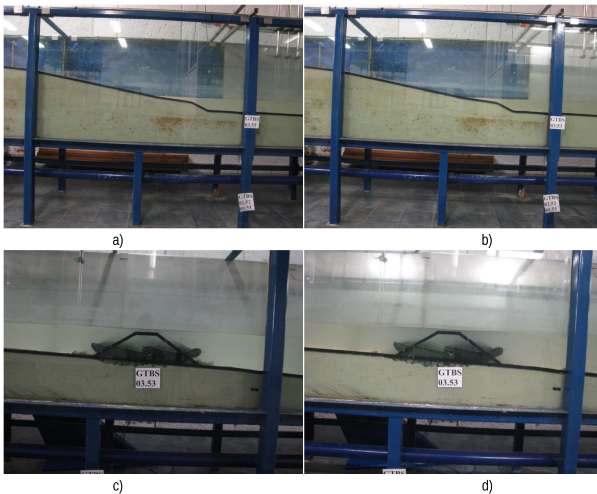
Figura C.74 Condiciones de la prueba GTBS0353. a) Perfil inicial de la playa, b) Perfil final de la playa, c) Condición inicial de la estructura, d) Condición final de la estructura
