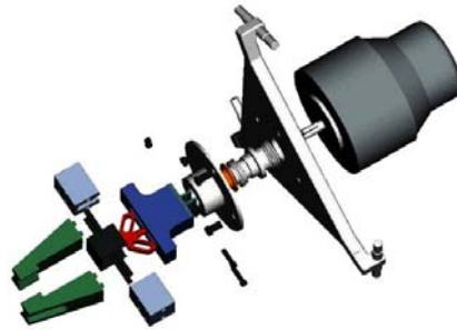
Imagen 9 Ejemplo de efector final para un brazo robótico
