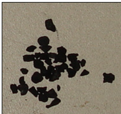
Figura 4.2. Carbón activado granular mineral de lignita usado como medio de soporte en el reactor AEBR
