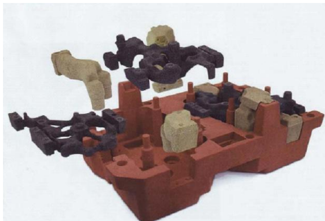
FIGURA 2.23 Corazones producidos por diferentes técnicas durante su ensamble
