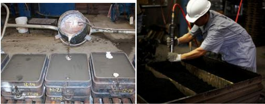
FIGURA 2.7 Izquierda vaciado de aluminio en moldes de arena en verde. Derecha, compactado de la arena alrededor del modelo
