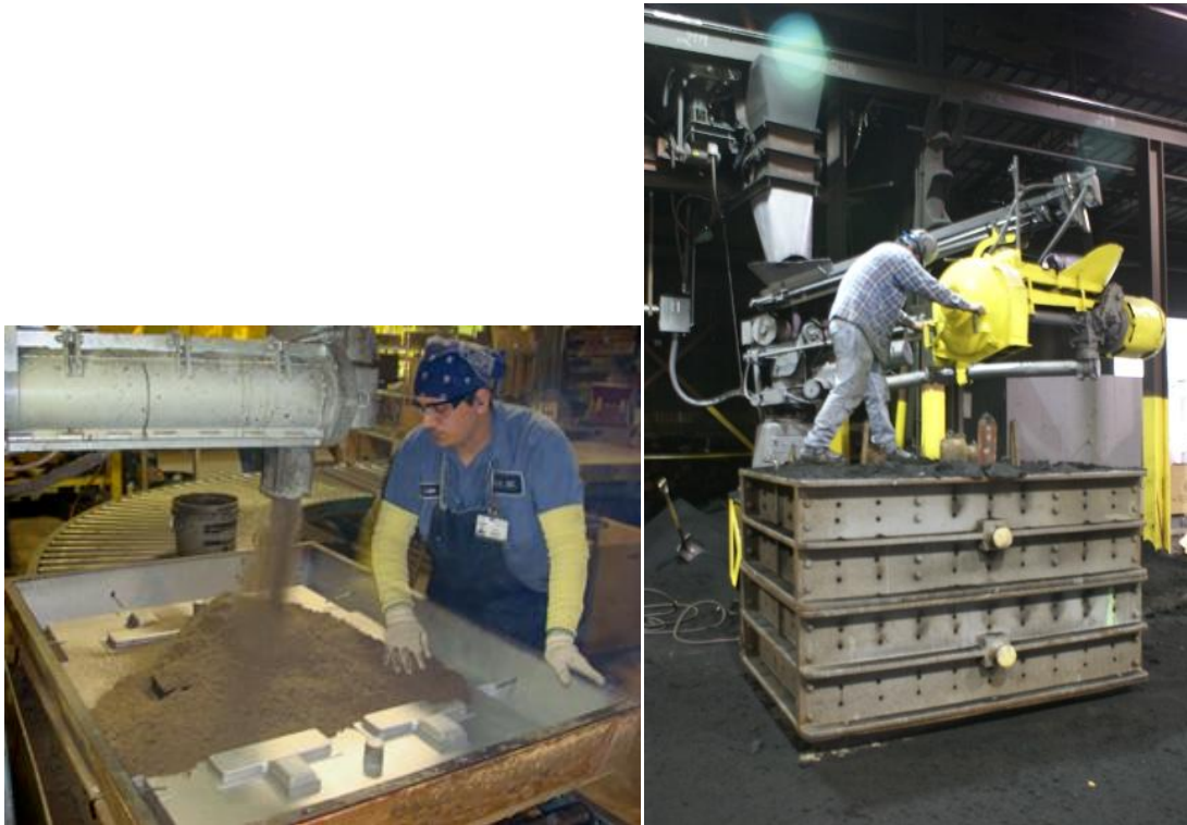
FIGURA 2.19 Moldeo con arena en verde de piezas de grandes dimensiones
