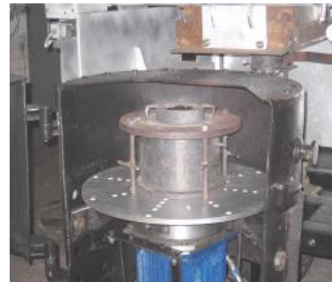
FIGURA 2.14 Centrifugado. (a) Descripción esquemática para centrifugado en eje horizontal (b) Máquina para centrifugado vertical
