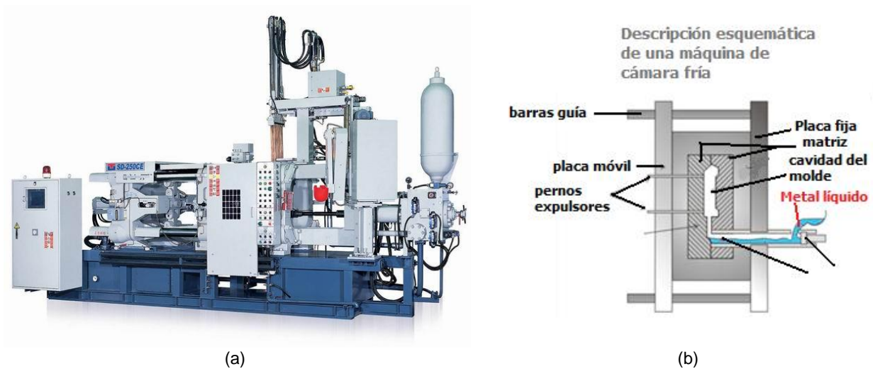
FIGURA 2.11(a) Máquina para inyección de metales, (b) Descripción esquemática del proceso
