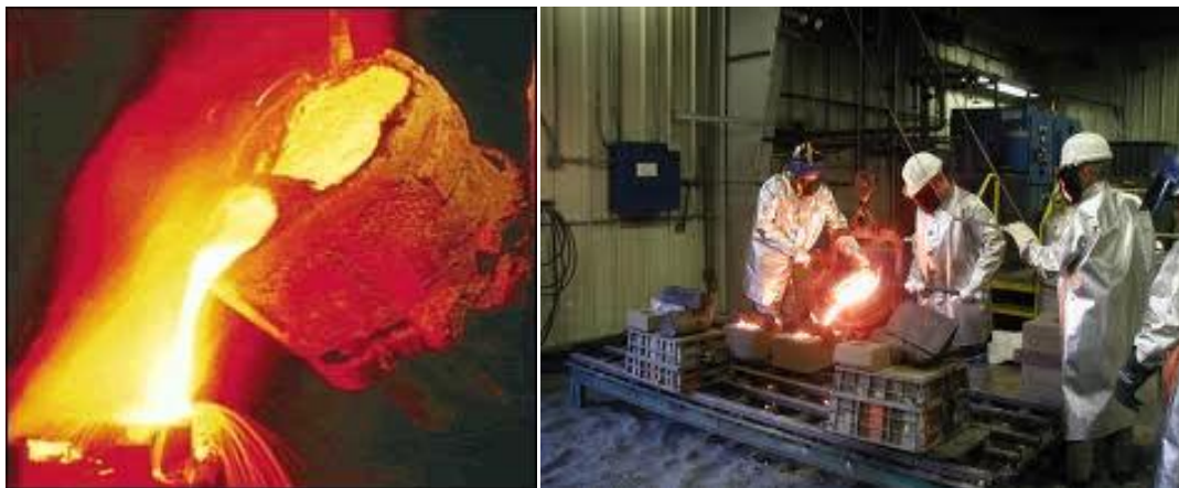
FIGURA 2.30 Vaciado del metal en el molde
