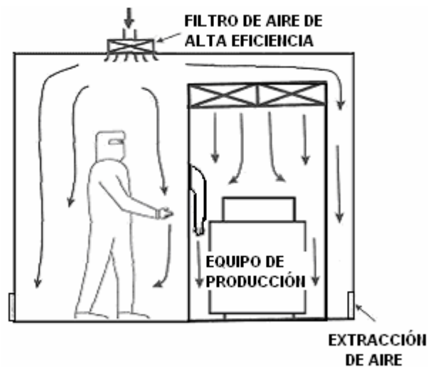
Figura 2.17 Cuarto limpio con aislador
