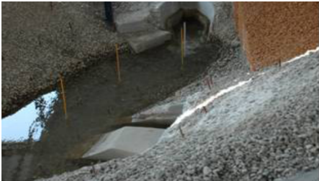
Figura 5.27 Nivel de agua en el desfogue de generación, elevación 397.15 msnm (Laboratorio de Hidráulica, CFE, 2007)
