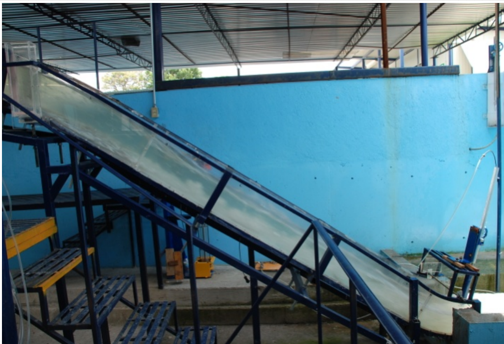
Figura 4.41 Flujo de agua a través de la rápida en modelo hidráulico para gasto máximo de 15 110 ( \text{m}^3/\text{s} ), equivalentes a 5 037 ( \text{m}^3/\text{s} ) en prototipo (Laboratorio de Hidráulica, CFE, 2010)
