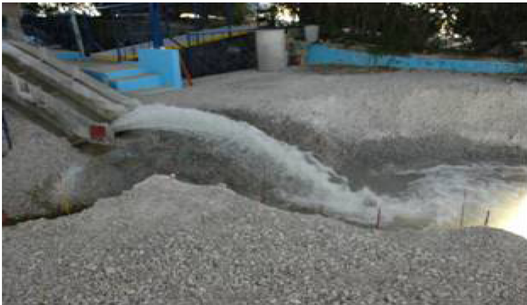
Figura 5.22 Descarga del flujo por el canal central para un gasto de 5\,037\text{ m}^3/\text{s} (Laboratorio de Hidráulica, CFE, 2007)
