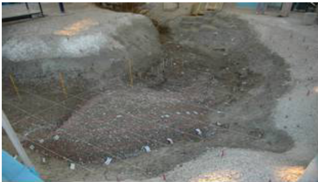
Figura 5.33 Erosión-depósito de material del cauce en modelo hidráulico para un gasto de 5\,037\text{ m}^3/\text{s} por canal, operando los tres canales (Laboratorio de Hidráulica, CFE, 2007)
