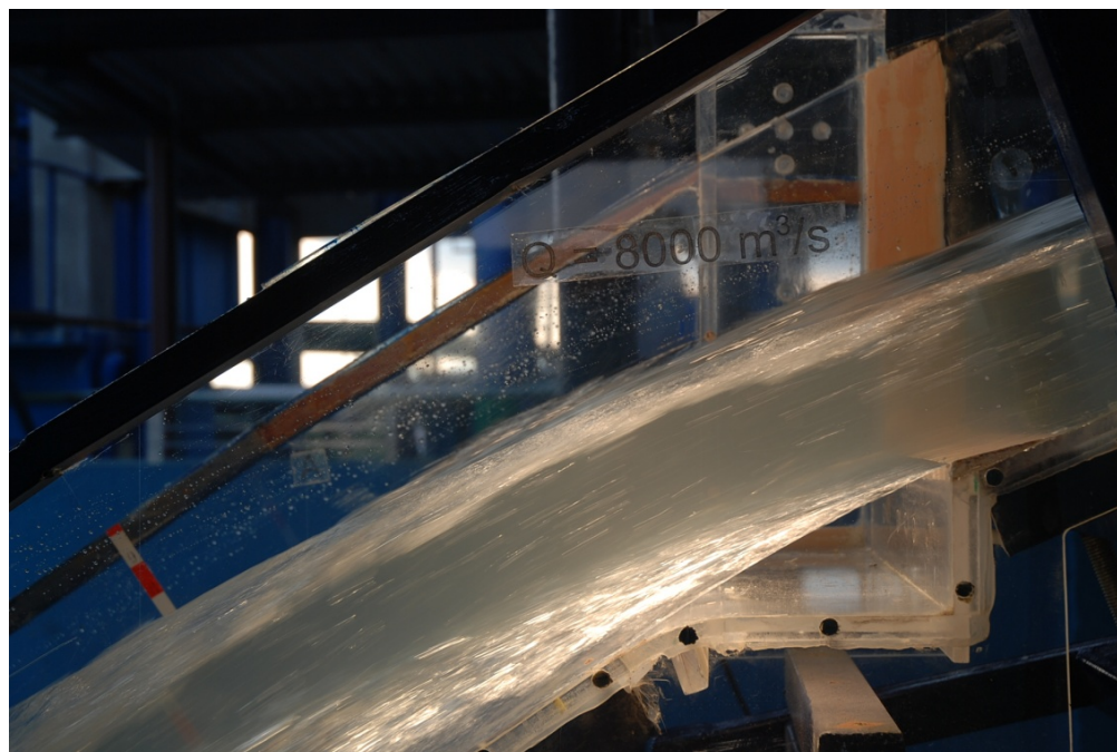
Figura 4.33 Aireador en modelo hidráulico para gasto de 8 000 (m 3 /s) equivalentes a 2 550 (m 3 /s) (Laboratorio de Hidráulica, CFE, 2010)
