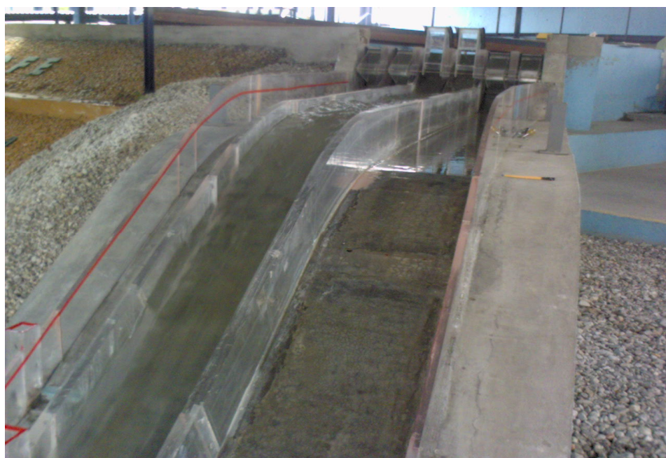
Figura 3.12 Curva vertical del modelo de canal de excedencias 1:75 (Laboratorio de Hidráulica, CFE, 2010)
