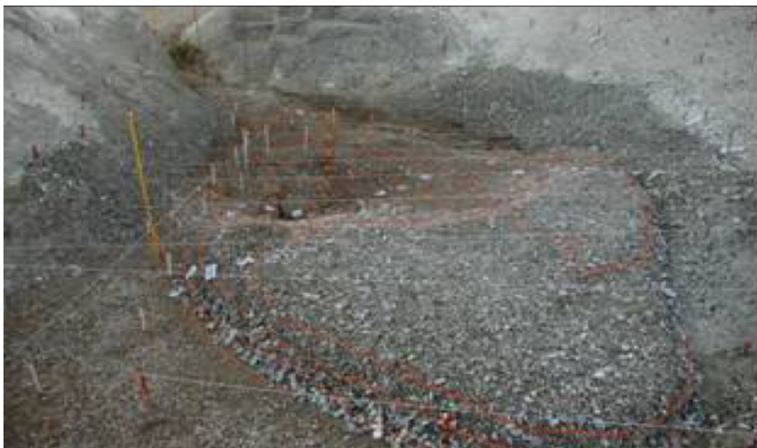
Figura 5.25 Erosión-depósito de material del cauce en modelo hidráulico para un gasto de 5\,037\text{ m}^3/\text{s} y operando solo el canal central (Laboratorio de Hidráulica, CFE, 2007)
