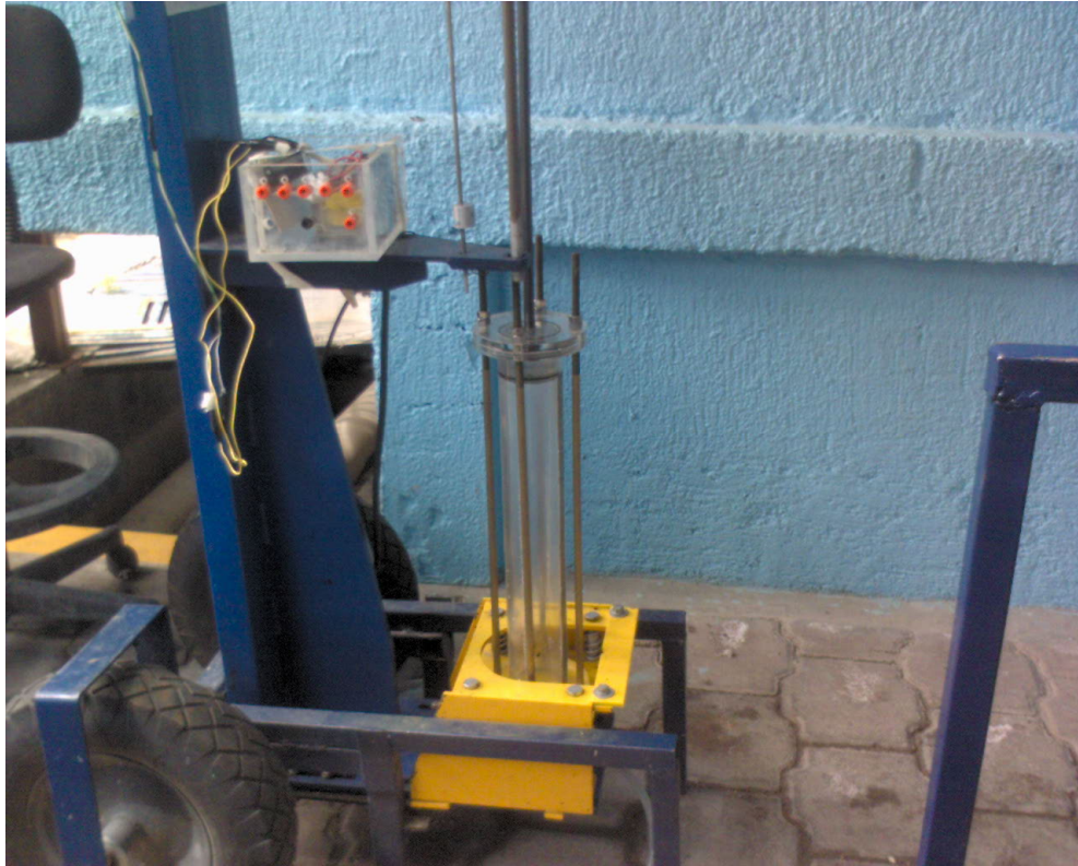
Figura 4.46 Dispositivo medidor de concentración de aire muestreador (Laboratorio de Hidráulica, CFE, 2010)
