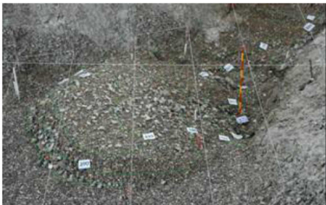
Figura 5.28 Erosión en el cauce en modelo hidráulico para un gasto de 850 m 3 /s por canal, operando los tres canales (Laboratorio de Hidráulica, CFE, 2007)
