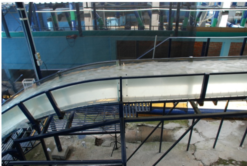
Figura 4.38 Flujo de agua a través del modelo hidráulico para gasto máximo de 15 110 ( \text{m}^3/\text{s} ) equivalente a 5 037 ( \text{m}^3/\text{s} ) en prototipo (Laboratorio de Hidráulica, CFE, 2010)
