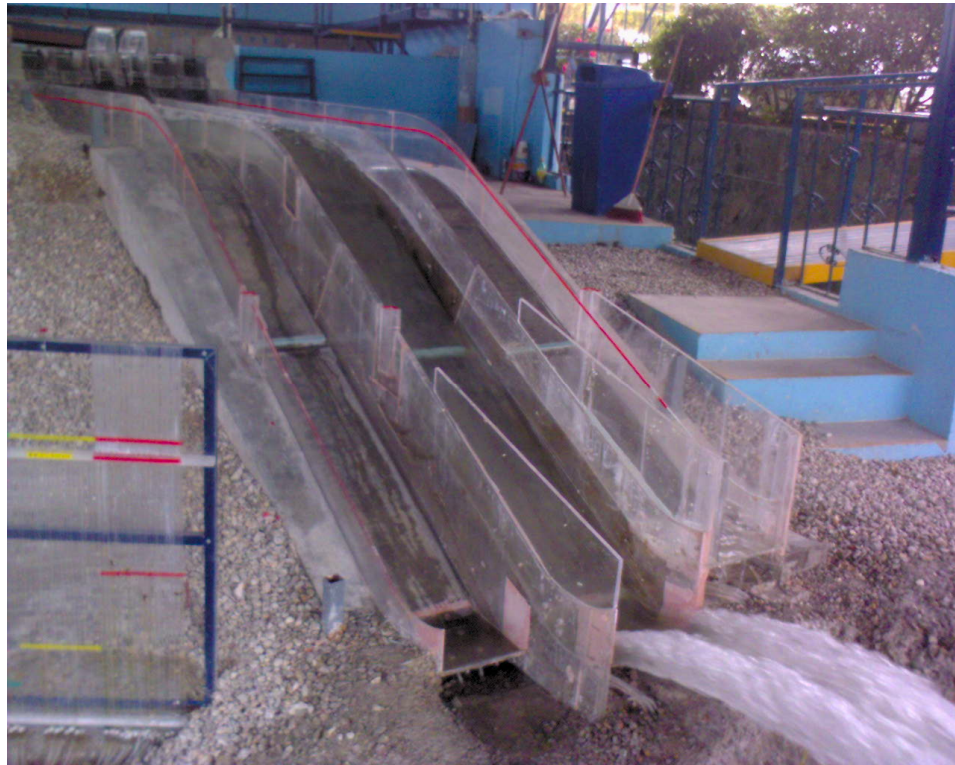
Figura 3.13 Cubeta de lanzamiento. Modelo 1:75 (Laboratorio de Hidráulica, CFE, 2010)
