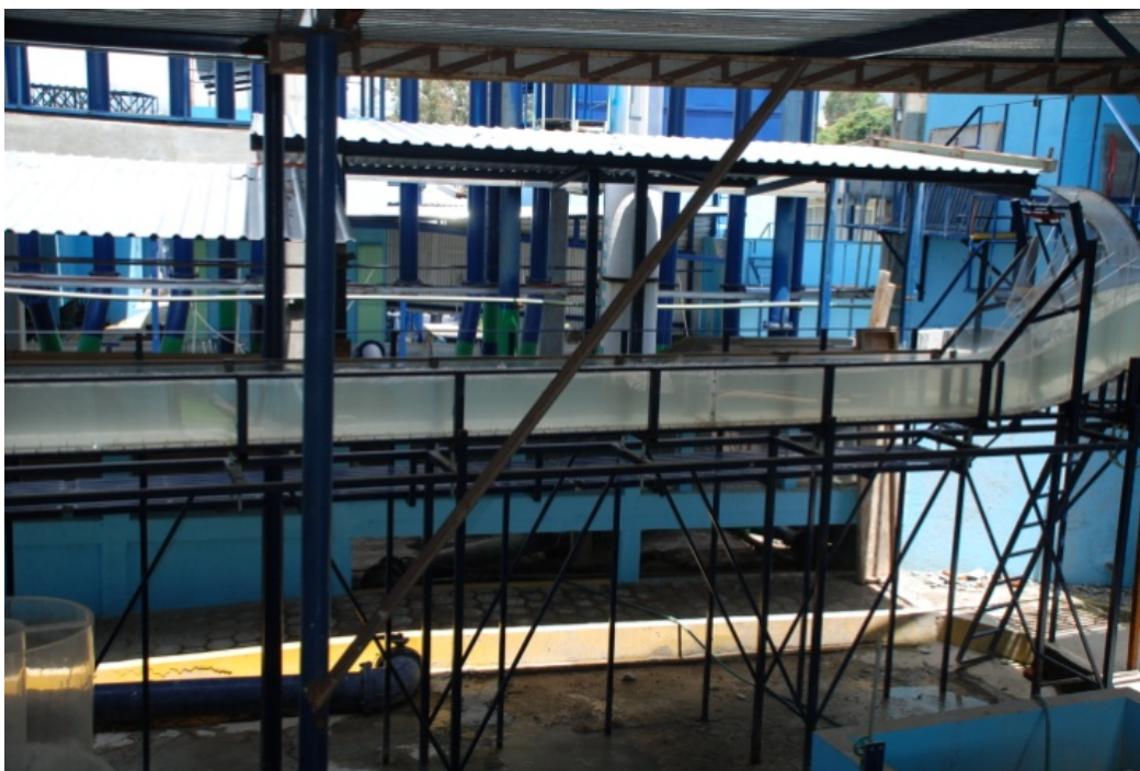
Figura 4.38 Flujo de agua a través del modelo hidráulico para gasto máximo de 15 110 ( \text{m}^3/\text{s} ) equivalente a 5 037 ( \text{m}^3/\text{s} ) en prototipo (Laboratorio de Hidráulica, CFE, 2010)
