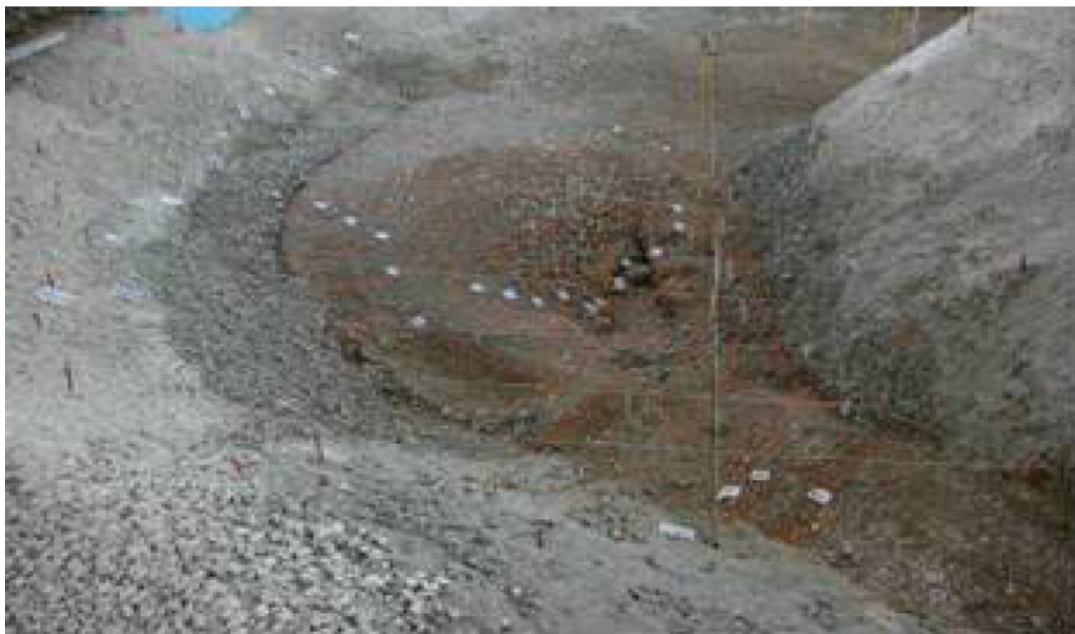
Figura 5.24 Erosión en el cauce en modelo hidráulico para un gasto de 5\,037\text{ m}^3/\text{s} y operando solo el canal central (Laboratorio de Hidráulica, CFE, 2007)
