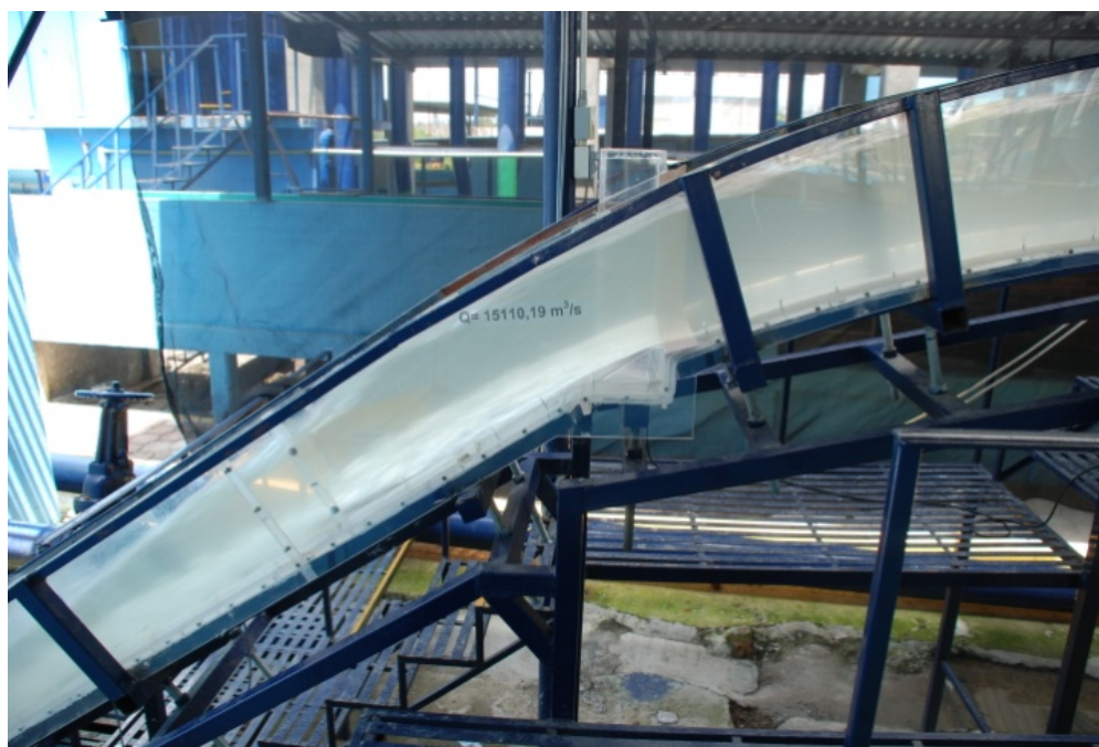
Figura 4.42 Flujo de agua a través del aireador en modelo hidráulico para gasto máximo de 15 110 ( \text{m}^3/\text{s} ) equivalentes a 5 037 ( \text{m}^3/\text{s} ) en prototipo (Laboratorio de Hidráulica, CFE, 2010)
