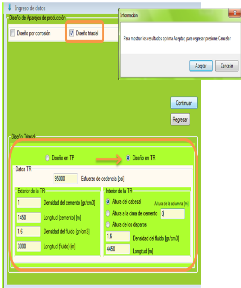
IMAGEN IV. 19 Pantalla de inserción de datos particulares para la operación de “aparejos de producción”. En el recuadro inferior se aprecia que se ha seleccionado “diseño de TR y los datos ingresados.
