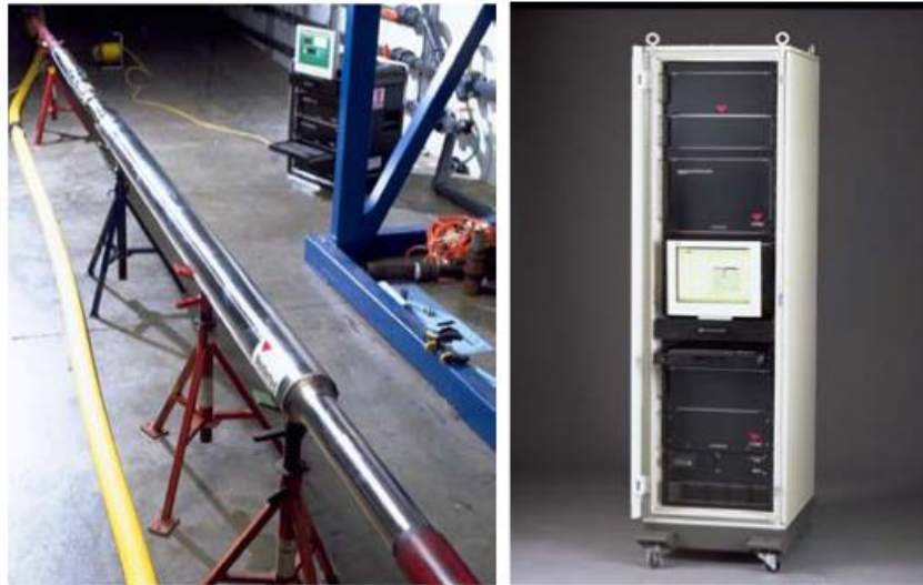
Fig. 3.10 - Sistema de Medidor de Flujo totalmente armado con Unidad de Instrumentación de Superficie.
