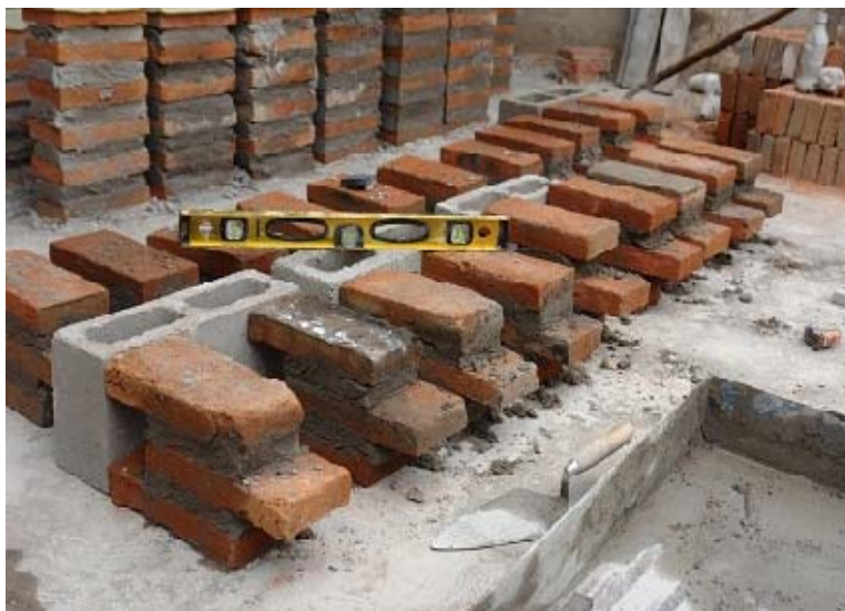
Figura 11.- Especímenes para la determinación de la adherencia entre piezas y mortero.
