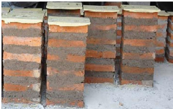
Figura 7.- Especímenes para obtener la resistencia a compresión de la mampostería los cuales muestran una junta de 4 cm.
