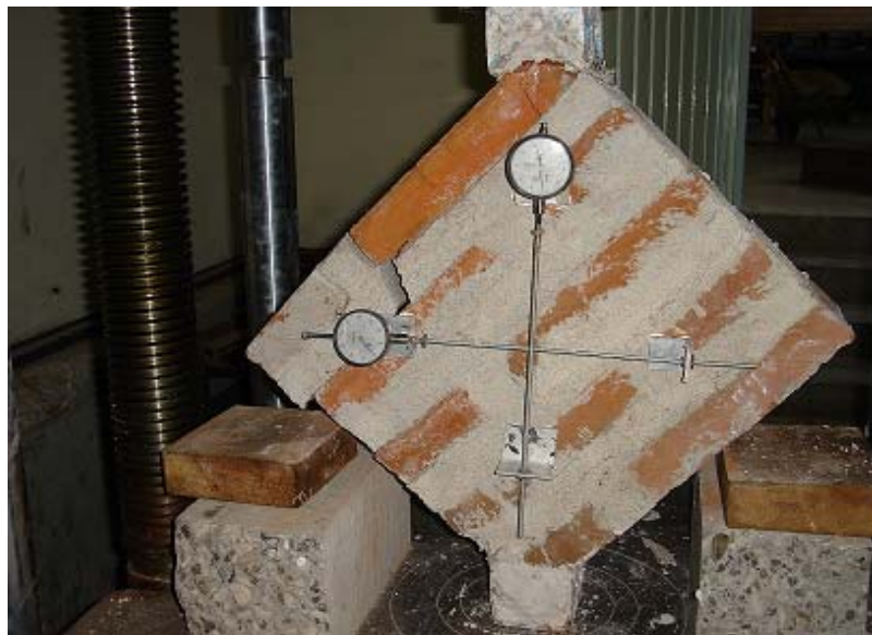
Figura 18.- Falla presentada debido a falta de adherencia entre la pieza y la junta.
