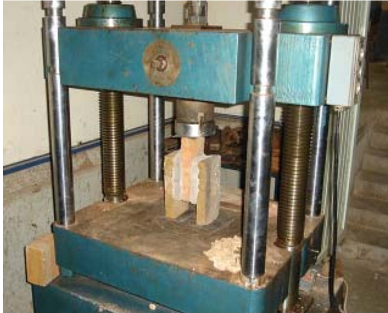
Figura 12.- Procedimiento de ensaye para determinar la adherencia
