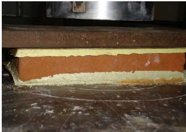
Figura 1.- Procedimiento de carga ensaye a compresión
