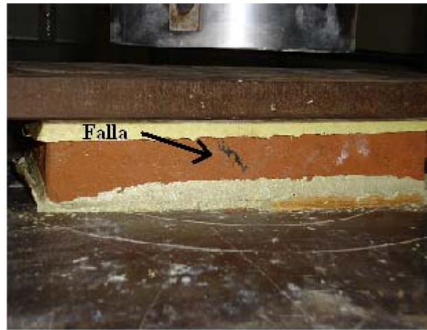
Figura 13.- Ensayo de pieza entera de tabique con falla localizada cercana al centro. El otro tipo de falla se presentó aproximadamente en los extremos de las piezas en su lado más largo. Esto pudo haber sido causado debido al cabeceo de las piezas las cuales presentaban irregularidades y por este motivo ocasionaba que el cabeceo no fuera uniforme.
