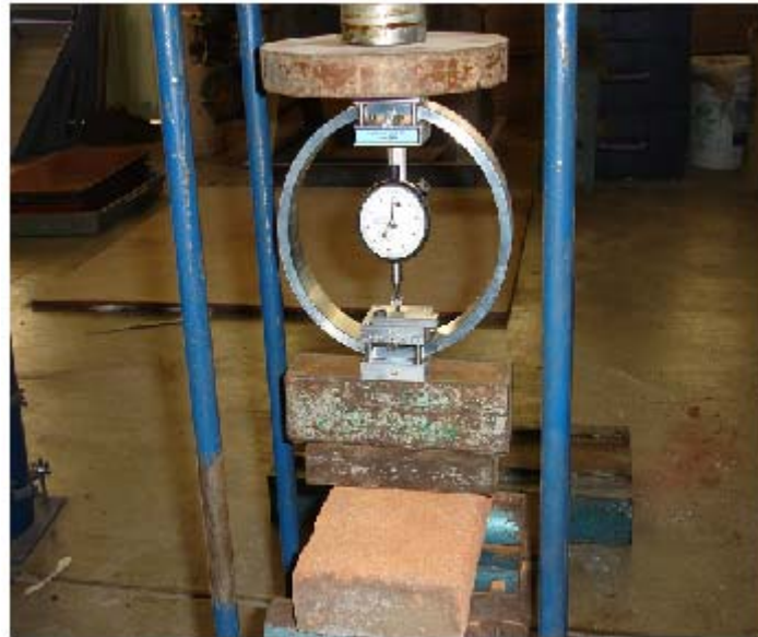
Figura 2.- Ensayo de una pieza de tabique para determinar el módulo de ruptura
