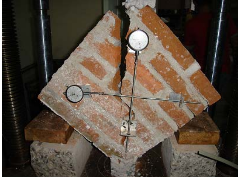
Figura 17.- La falla se presentó siguiendo la diagonal principal del espécimen. Dichos muretes presentaban resistencias uniformes las cuales se asemejaban a los resultados que se podrían esperar del ensaye.
