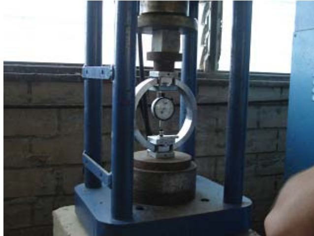
Figura 6.- Ensayo de cubo de mortero
