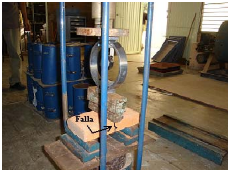
Figura 15.- La falla se presentó en una zona cercana al centro de la pieza
