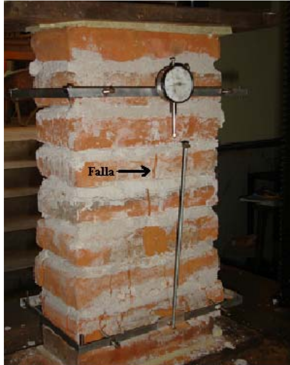
Figura 17.- La falla se presentó del centro hacia los extremos del espécimen
