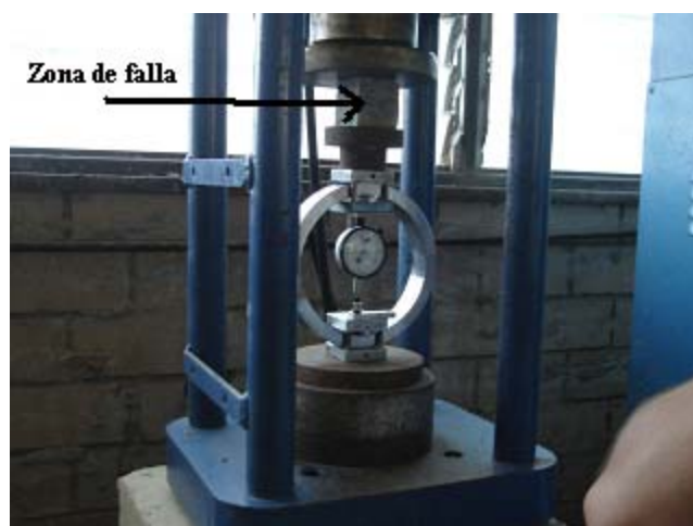
Figura 16.- La zona de falla se encuentra en la parte media de la pieza Comparación con lo establecido
