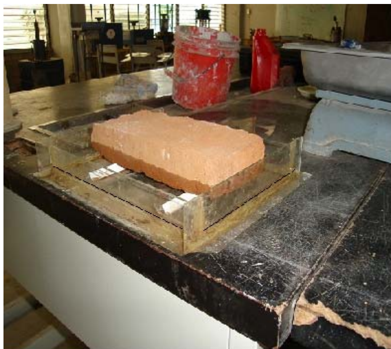
Figura 4.- Recipiente para obtener la absorción inicial
