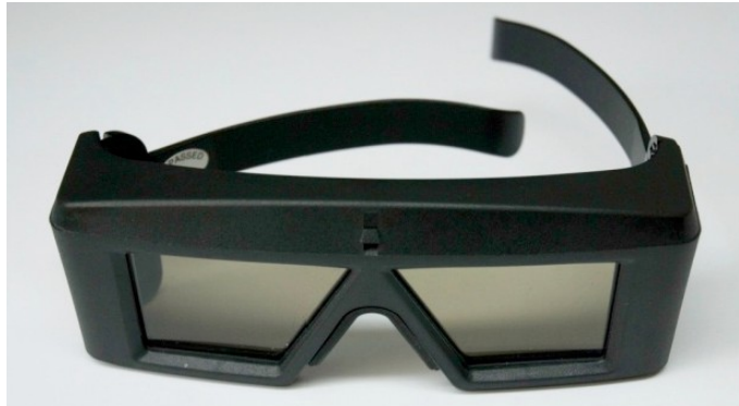
Fig. 3.3.2.c.2. Sistema de Obturación.
