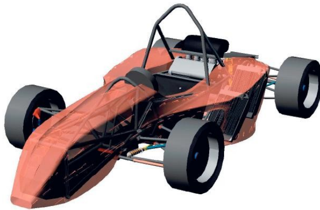
Fig. 2.4.3.1.a. Prototipo de Diseño Aerodinámico de la Carrocería de un Vehículo FSAE con ADMS.
