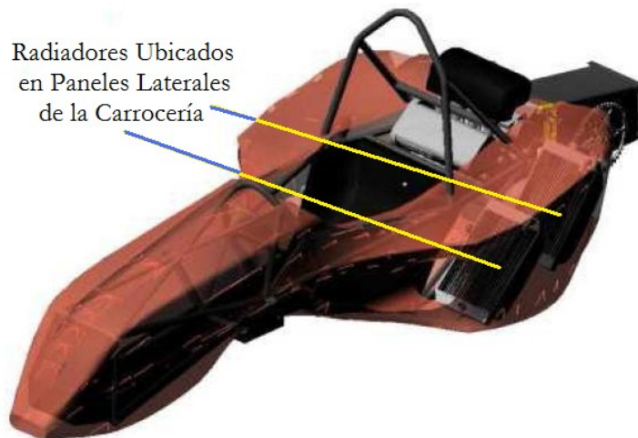
Fig. 4.1.2.6. Sistema de Enfriamiento por Aire (Paneles Laterales).
