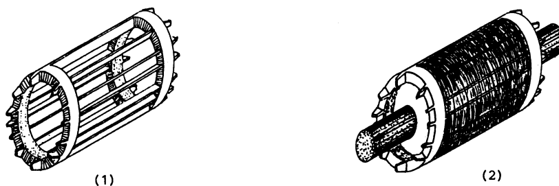
FIGURA 3.7. ROTOR DEL MOTOR DE INDUCCIÓN. (1) CIRCUITO DE JAULA DE ARDILLA. (2) ASPECTO DEL ROTOR.
