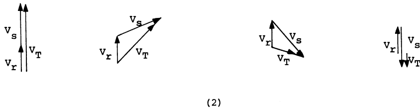
FIGURA 3.39. REGULADOR DE VOLTAJE. (1) ESQUEMA DE CONEXIONES. (2) SUMA DE VOLTAJES PARA DIFERENTES POSICIONES DEL ROTOR.
