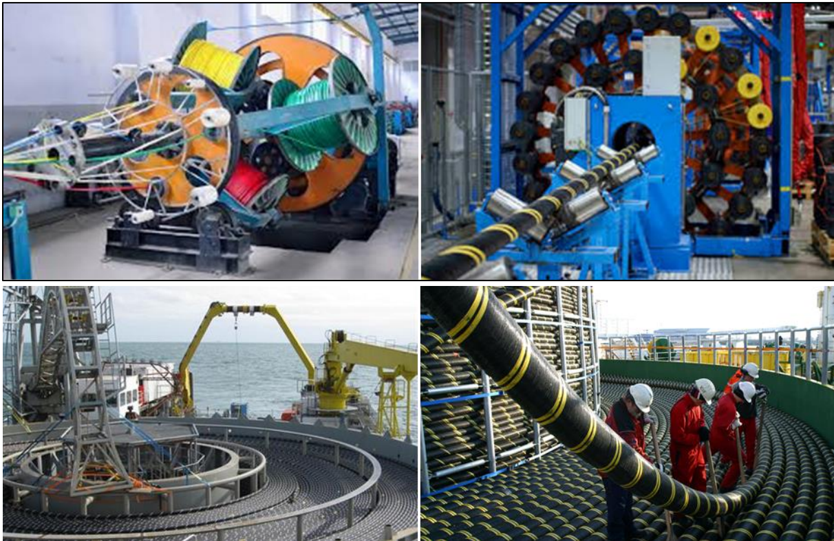
Figura 9 Fabricación y almacenaje de un cable umbilical. Fuente: elaboración propia
