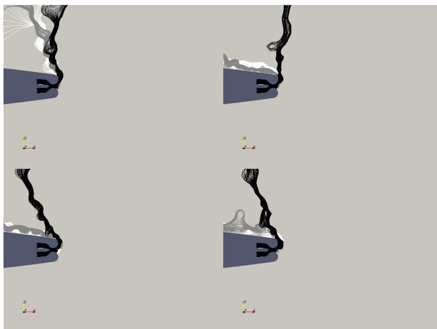
Figura 4.34: Avance en el tiempo de líneas de corriente para el caso con \dot{m}^*=0.75 y diferentes números de Reynolds
