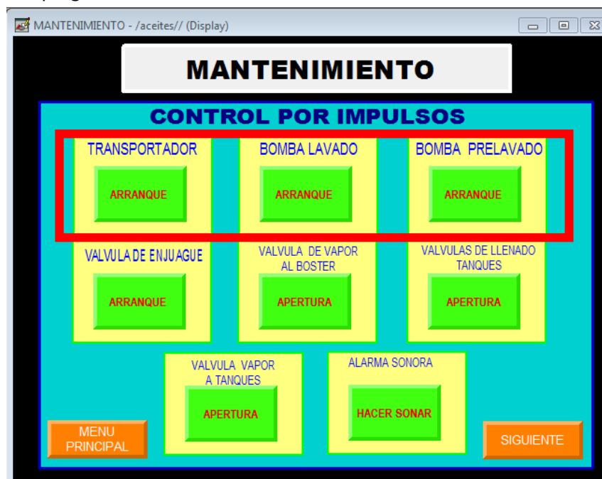
Fig. 6.42 Pantalla HMI Mantenimiento
