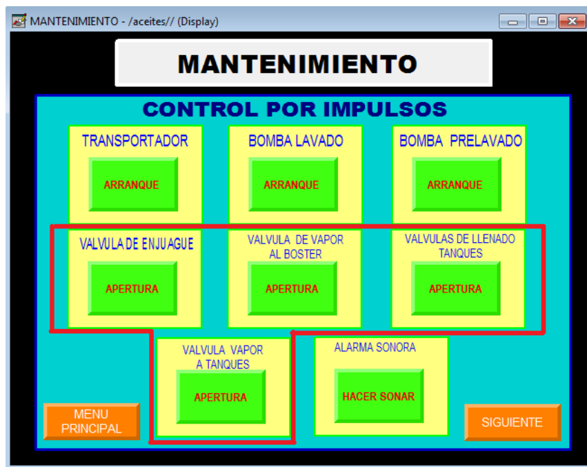
Fig. 6.43 Pantalla HMI Mantenimiento
