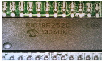
Figura 2.16: Microcontrolador de una tarjeta controladora visto bajo un microscopio
