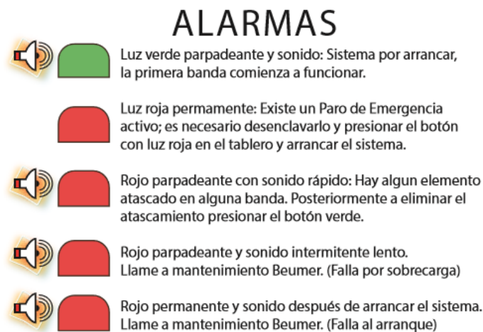
Figura 2.8: Ejemplo funcionalidad de torretas en campo
