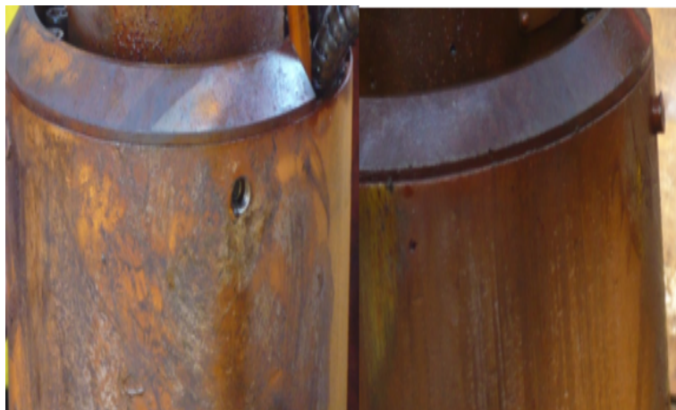
Figura 4.1: Alineación de orificios de la camisa de enfriamiento con el adaptador de la misma.
