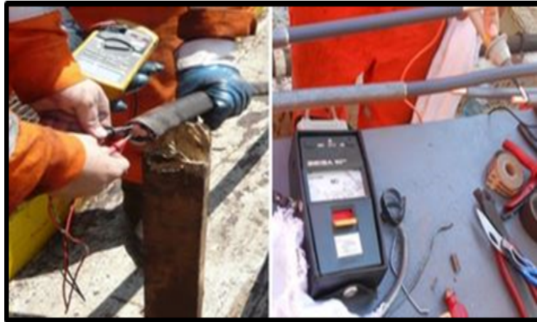
Figura 2.38: Instrumentos de medición eléctrica: voltímetro (derecha) y megóhmetro (derecha).
