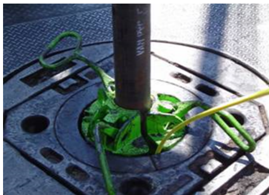
Figura 4.4: Cable entrando al pozo mientras las cuñas están sosteniendo la tubería.
