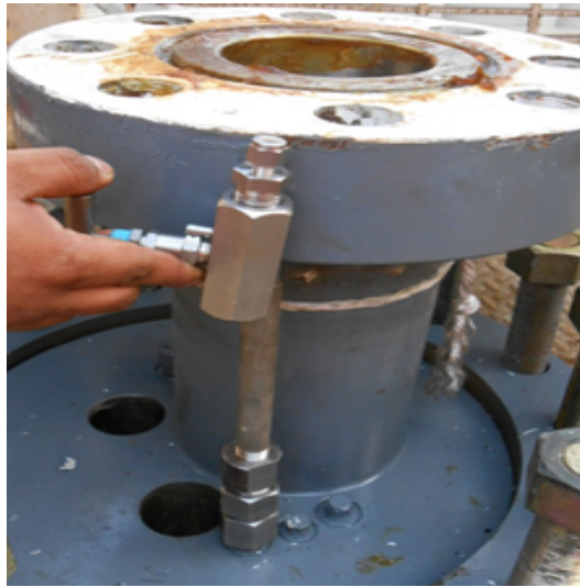
Figura 3.11: Tornillo de terminación presentado en bonete.
