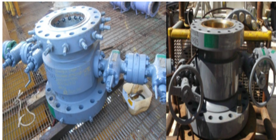
Figura 3.9: Cabezales de producción con yugos (izquierda) y sin yugos (derecha).
